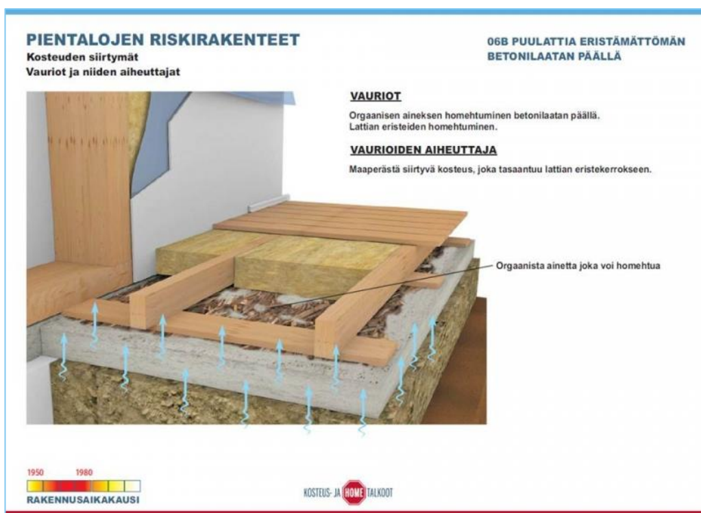
KUVA 3. Puukoolattu maanvarainen alapohja. (1970-luvun talo)
