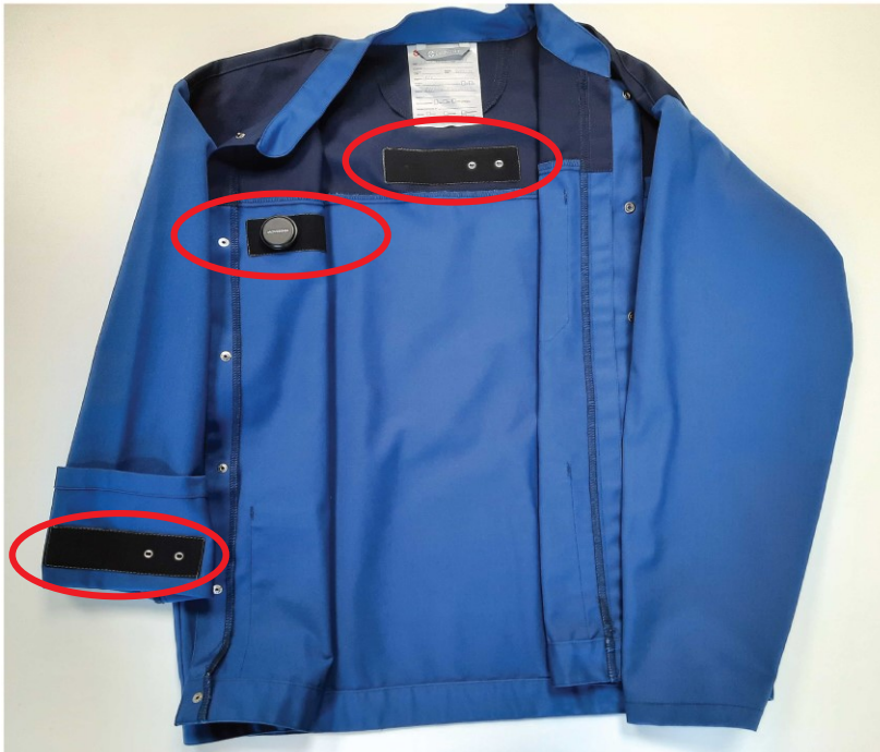
Kuva 3. Sensorien sijoituspaikat testitakissa.
