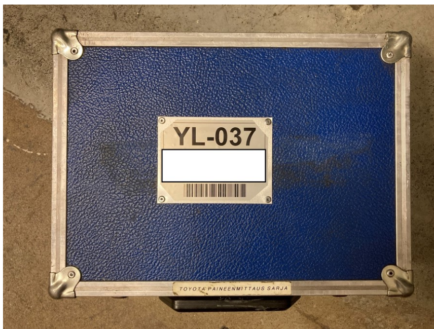
Kuva 5. Pop-niiteillä kiinnitetty alumiininen tunnistekyltti.
