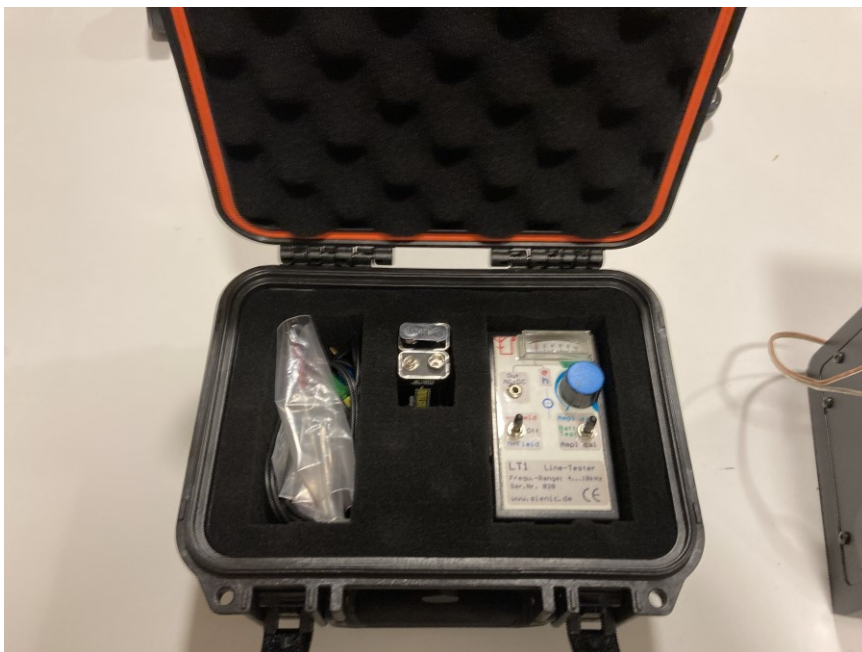
Kuva 4. Testerilaitte ja lisäosat, joille muovailtu kolot pehmusteeseen.
