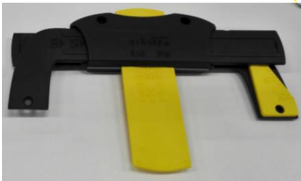
Kuva 20. Rakotulkki, jolla voidaan määrittää KSO Poistoilmaventtiilin avautuma.
