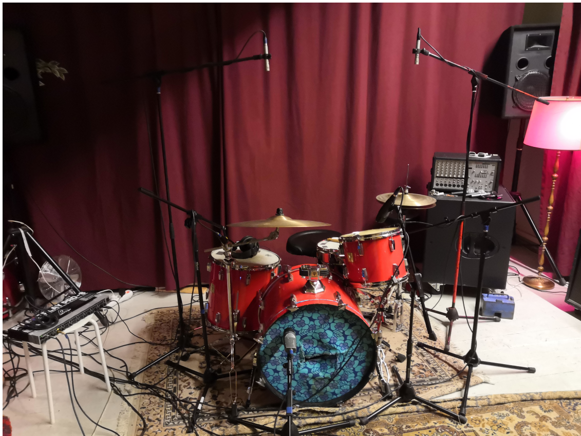
KUVA 12. Rumpujen mikitys analogisissa äänityksissä. Kuvassa vasemmalla soittajien kuunteluun tarkoitettu Behringer-merkkinen 8-kanavainen kuulokevahvistin.
