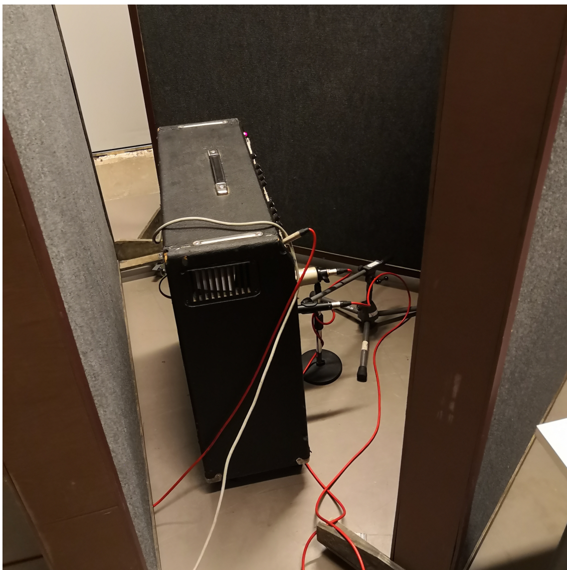
KUVA 7. Bassovahvistin sijoitettiin viereiseen varastuhuoneeseen vuodon takia. Varastossa resonoivien materiaalien takia paikkaa jouduttiin hakemaan useampaan kertaan. Sermejä käytettiin vaimennukseen.
