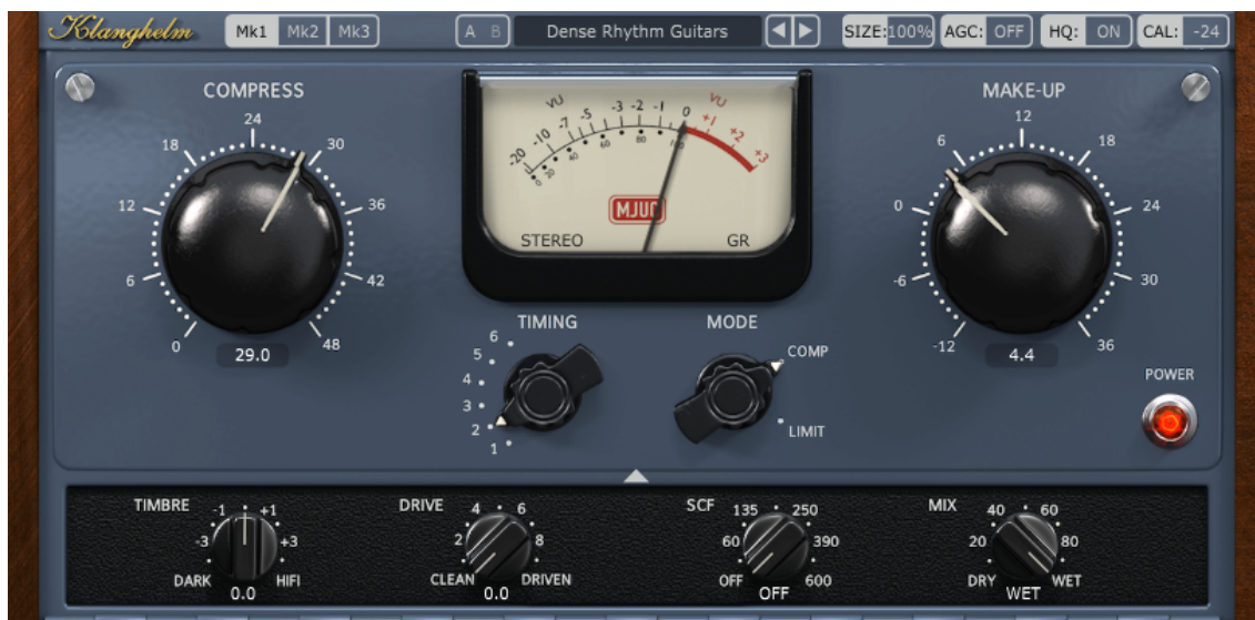
KUVA 16. Klanghelm MJUC variable-mu -kompressori. Kuvassa säädöt kitara-raidan kompressoimiseen.
