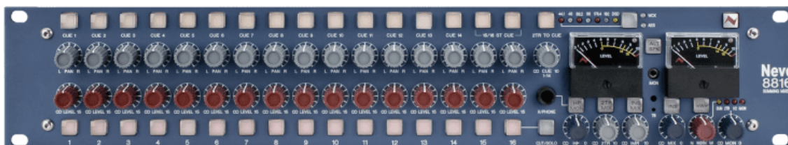
KUVA 19. AMS Neve 8816 -summausmikserin etupaneeli (ams-neve.com 2021).
