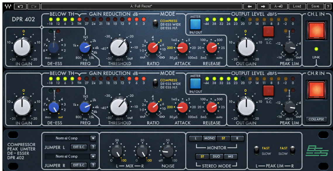
KUVA 3. Plugin-valmistaja Wavesin digitaalisen plugin-kompressorin, BSS-DPR-402:n käyttöliittymä. (Waves.com 2021)
