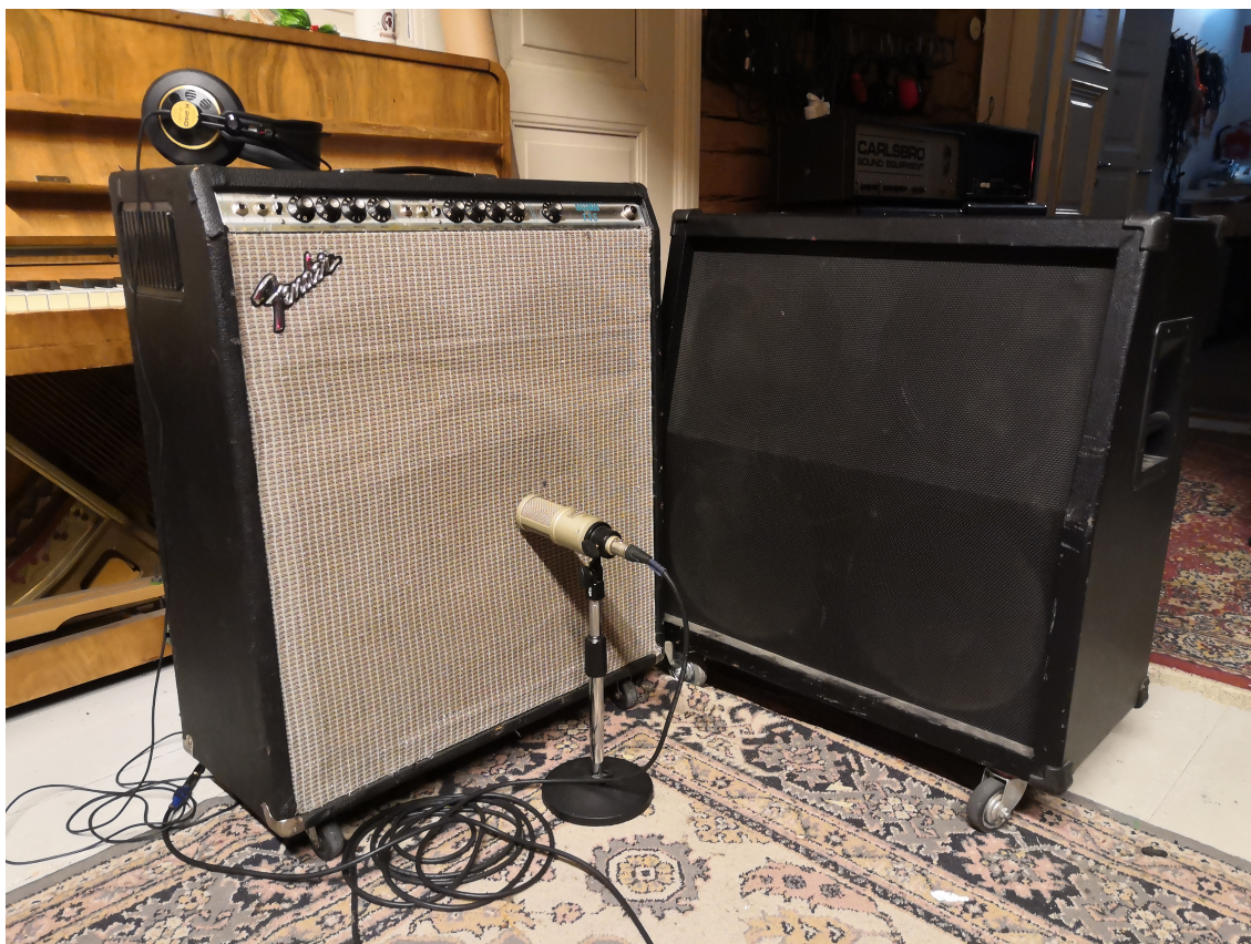
KUVA 13. Fender Bassman bassovahvistimen mikitys analogisissa äänityksissä. Oikealla olevan kaapin tarkoitus on vaimentaa oikealta tulevaa kitaravuotoa.
