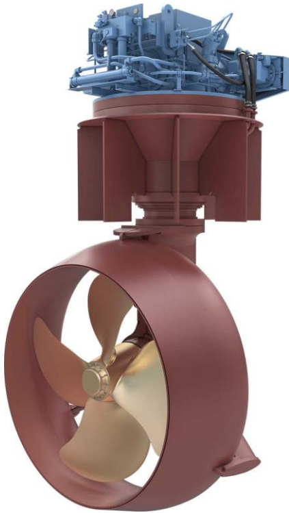
KUVA 1. US azimuth thruster. (Kongsberg)
