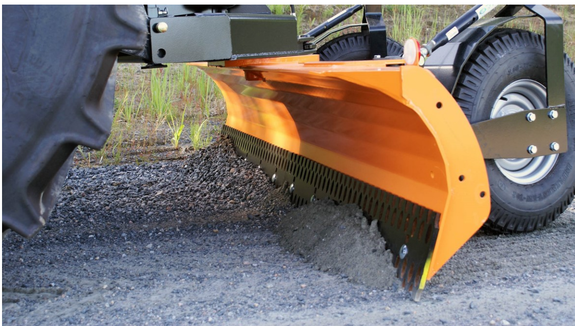
KUVA 5. Traktorivetoinen polanneterä. (FMG Oy)
