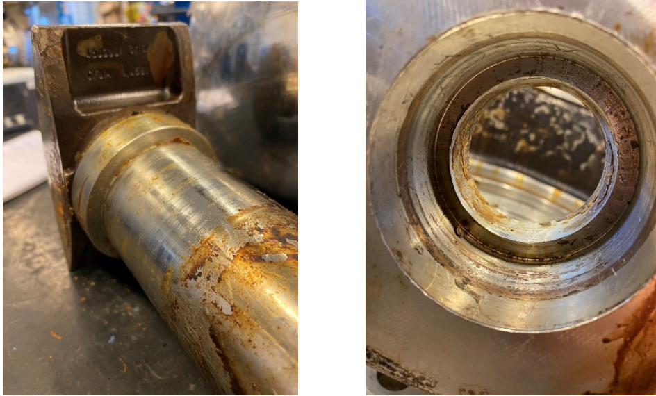
Kuva 13. Akseli ja poksi hyvässä kunnossa. Normaalista käytön kulumaa.
