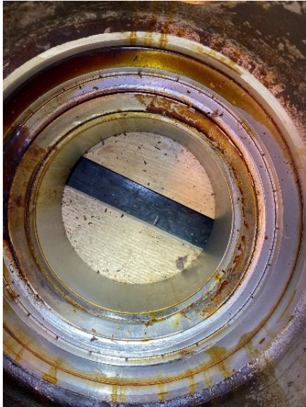
Kuva 11. Rungon puoleinen tiivistein kuluminen aiheuttanut myös pesän virtausaukon reunaan suurta kulumaa.
