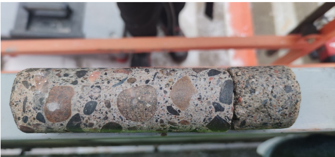
Kuva 10. Pintavalu on irrallaan kantavasta laatasta.
