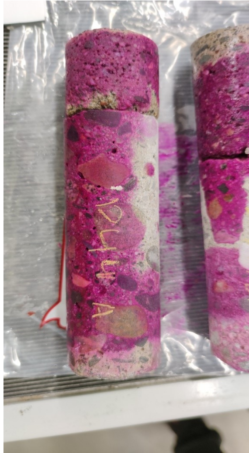
Kuva 12. Karbonisaatiokoe tehty. Koepaloissa on merkintä, josta nähdään mistä laatasta koepala on porattu. Koepalasta huomattavissa irrallinen pintavalu.
