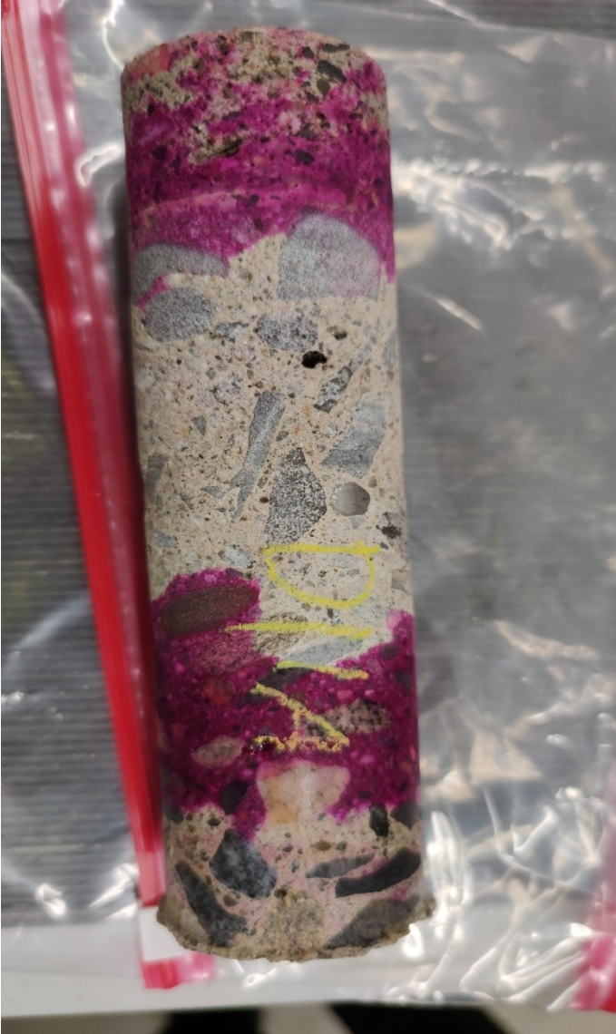
Kuva 4. Fenoliftaeiiniliuoksella kriittisiltä alueilta näytteen päistä sivelty koekappale.
