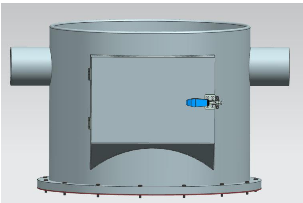
Kuva 14. Uusi kaatosuppilo, imuputket ja säkinavausluukku.
