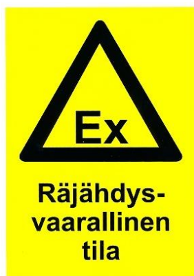
Kuva 5. Räjähdyksenvaarallisen laitteen tai tilan merkintä. (Metropolia 2021.)
