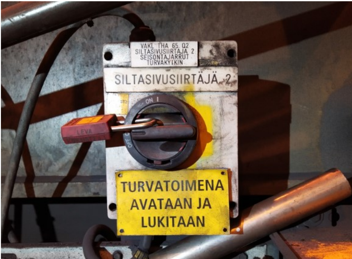
KUVA 6. Turvakytkin käännettynä nolla-asentoon ja lukittu turvalukolla
