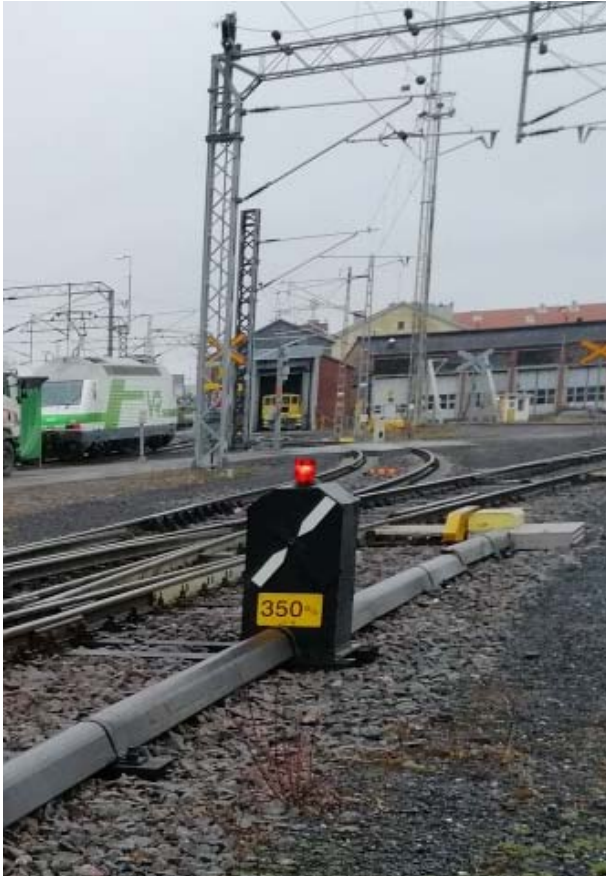
KUVA 22. Esimerkki häiriön ilmaisevasta valosta
