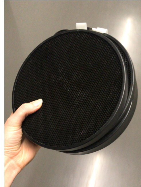
Kuva 45. Lainasin valokuvausstudioilta testattavaksi hunajakennogridit, joissa on eri paksuuksia ja kuviokokoja.
