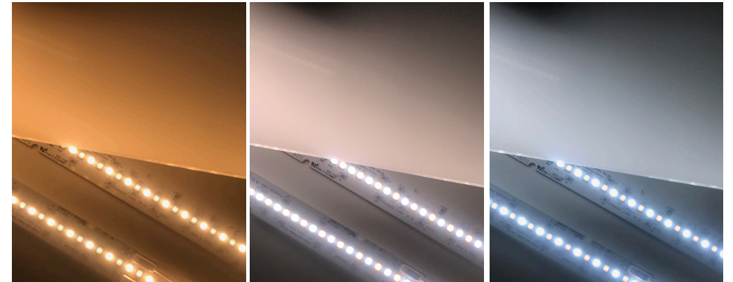
Kuvasarja 48. Testasin led-komponenttien värisävyjä. Ohjasin ledien värilämpötilaa Osram BT Control -sovelluksella. Vasemmalta oikealle värilämpötilat ovat 2 700 K, 4 500 K, 6 500 K.
