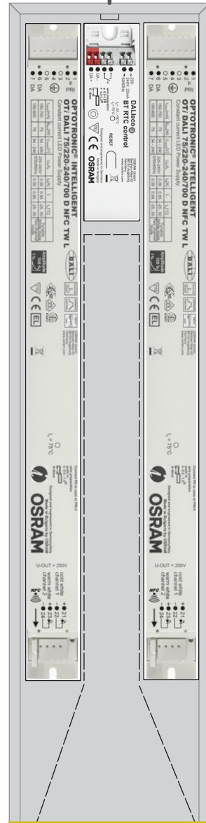
Kuva 66. Komponenttien sijoitus pystyosaan. Tilavaraukset valokuvio-LED:ille on merkitty katkoviivalla. Komponenttien kuvat Osram.
