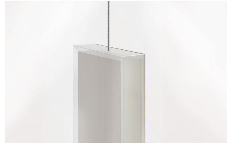
Kuva 59. Valokuvion luovat komponentit ja yleis- ja kirkasvalon driver ja controller ovat pystyosassa. Messinkinen sivu on kiinni magneeteilla, joten se lähtee kevyesti vetämällä irti. Satiiniset 6 mm akryylit liimataan kasaan ja sisäpinta maalataan messinkiä muistuttavalla maalilla, joka kuultaa kevyesti akryyliin läpi.
