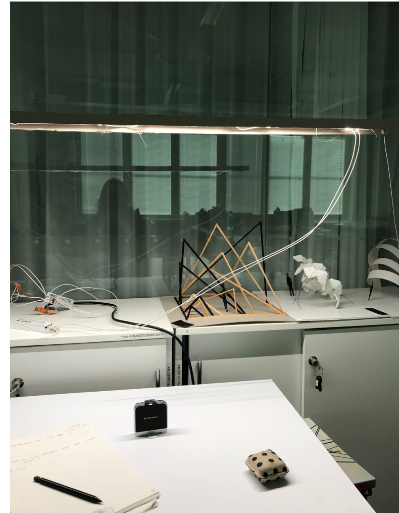
Kuva 54. Luksimäärän mittaus AsenseTekin Lighting Passport -mittalaitteella.
