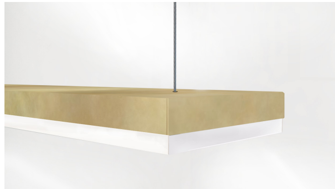
Kuva 57. Yksityiskohta valaisimen päädystä. Kirkkaaseen 108 x 20 mm akryyliin jyrkitty kolo keventää hieman painoa. Kolon pinta on tarkoitettu hioa satiinimaiseksi, jolloin ledit eivät näy sen läpi.
