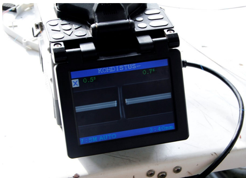
Kuva 3. Hitsattavien kuitujen kohdistaminen ennen hitsausta.
