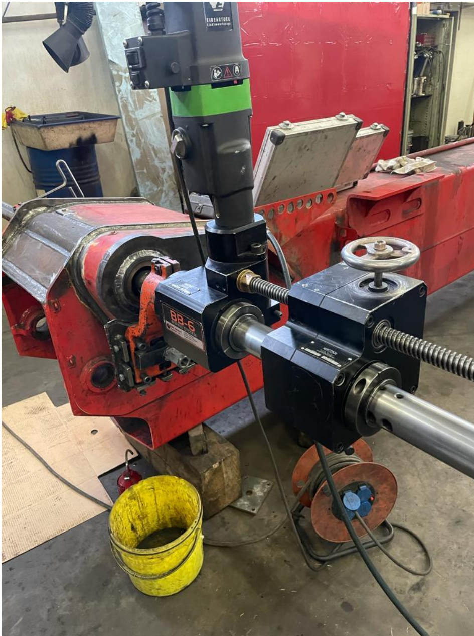
KUVA 25. Pora kohdistettu, poraus aloitettu
