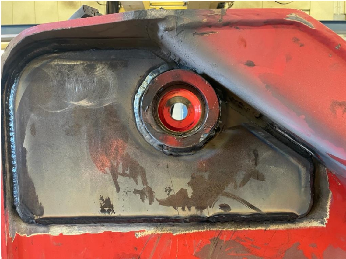
KUVA 21. Valmis korjaus rungon osalta
