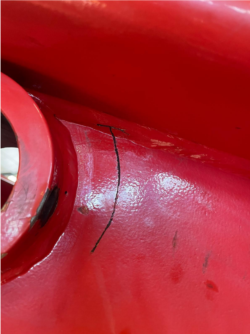
KUVA 17. Ratkeama koneen rungon ulkopinnalla
