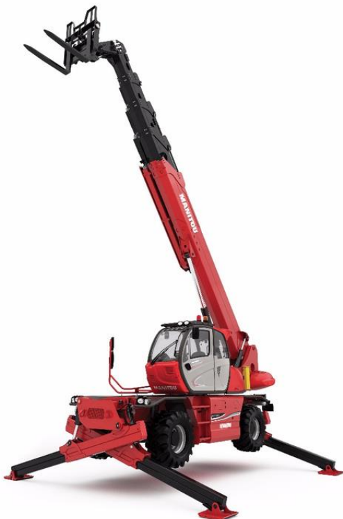
KUVA 1. Ympäripyörivällä ylävaunulla varustettu kurottaja (5)
