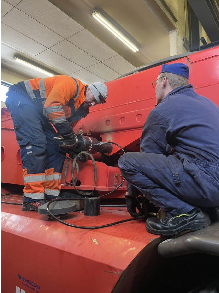
KUVA 10. Kierretanko hitsattu nostosylinterin tapin päähän, tapin irrottaminen aloitettu
