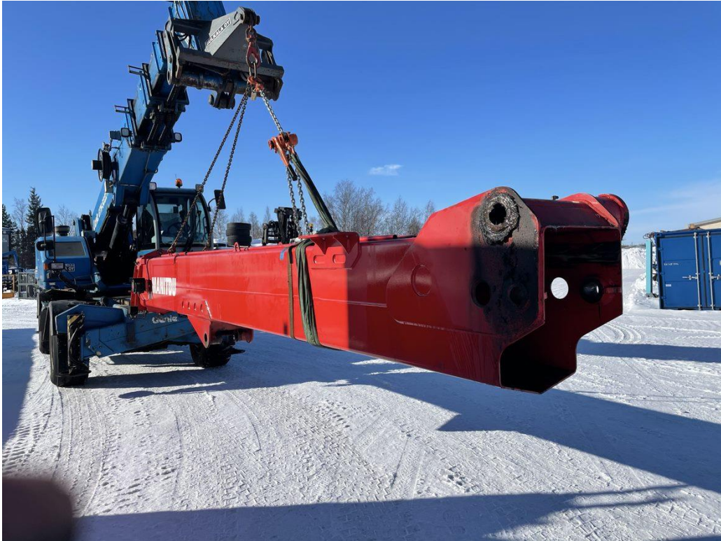
KUVA 12. Peruspuomi nostettu pois kurottajan rungosta
