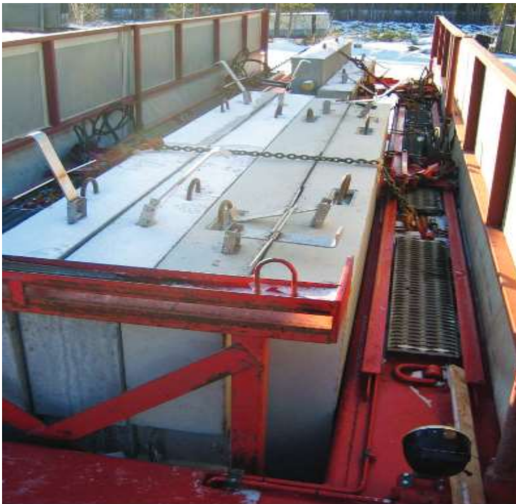
Kuva 3. Seinäelementtien kuljetus allasautolla, jossa korkeat sivulaidat. (Betonielementtien kuljetus. 2008.)
