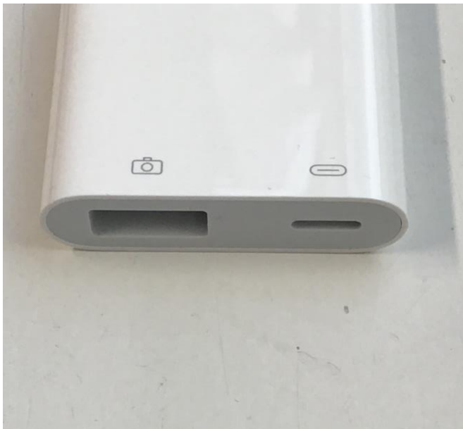
Kuvio 9. iPad-tabletin Lightning-liitäntä sovitetaan USB A:lle donglen avulla.
