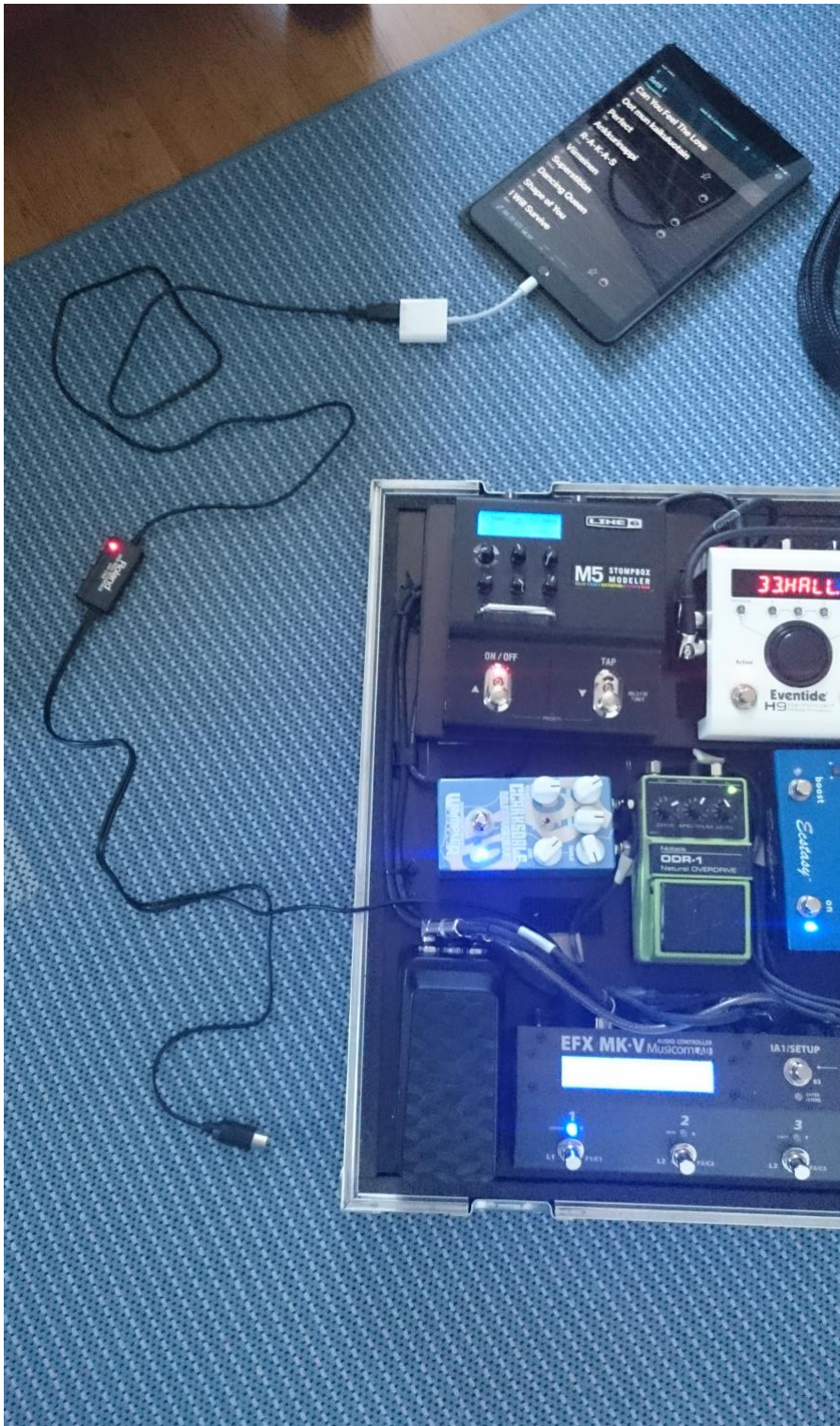
Kuvio 7. Pedaalilaudan komentokeskus, MusicomLab EFX MK-V, vastaanottaa tabletilta komentoja MIDI in -porttiin.
