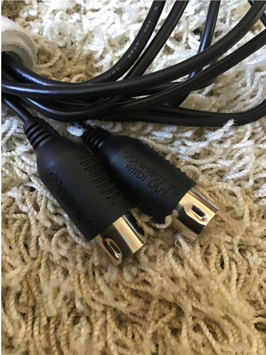
Kuvio 6. MIDI-kaapelit kykenevät viemään informaatiota vain yhteen suuntaan (Aikin 2003, 42). Tämä ei kuitenkaan tarkoita, että MIDI-johtimet sinänsä olisivat kuin yksisuuntaisia katuja. Informaatio kulkee kahden laitteen välillä normaalisti, mikäli toisesta lähtevät komennot menevät vastapuolen MIDI-sisääntuloon ja toisinpäin (loopop 2019). Kuvan tapaisessa adapterissa on tärkeää kytkeä jakit niihin kirjoitettujen ohjeiden mukaan, sillä adapteriin menevät johtimet vievät aina samaan paikkaan.
