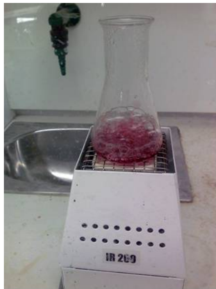
Kuva 11. Sokeripitoisuuden titrausta Rebeleinin pikamenetelmän mukaan
