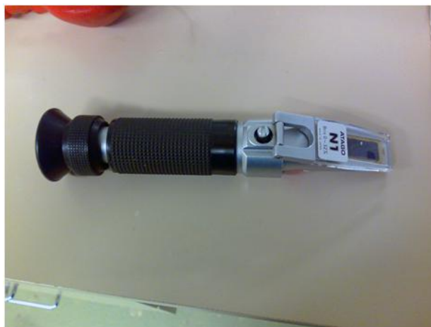
Kuva 9. Refraktometri, jolla mitataan liukoisten kuiva-aineiden (Brix)
