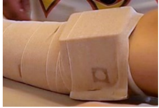
Kuva 6. Mittalaite kiinnitetty kiertämällä kompressiosidettä sen päälle.
