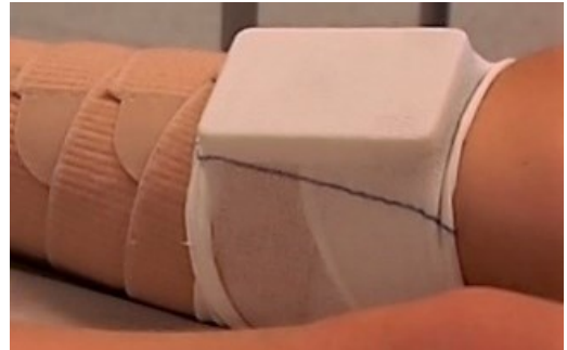
Kuva 8. Mittalaite kiinnitetty säärikompressiotekstiilin päälle erillisellä palalla putkisidosta.
