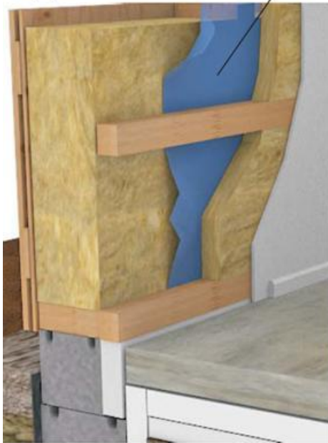
Kuva 15. Puurakenteisen ulkoseinän kosteuskondenssin muodostumista höyrönsulku muovin pinnalle sisätilan suhteellisen kosteuden eri arvoilla työmaaolosuhteissa (Heikkinen 2012: 41).
