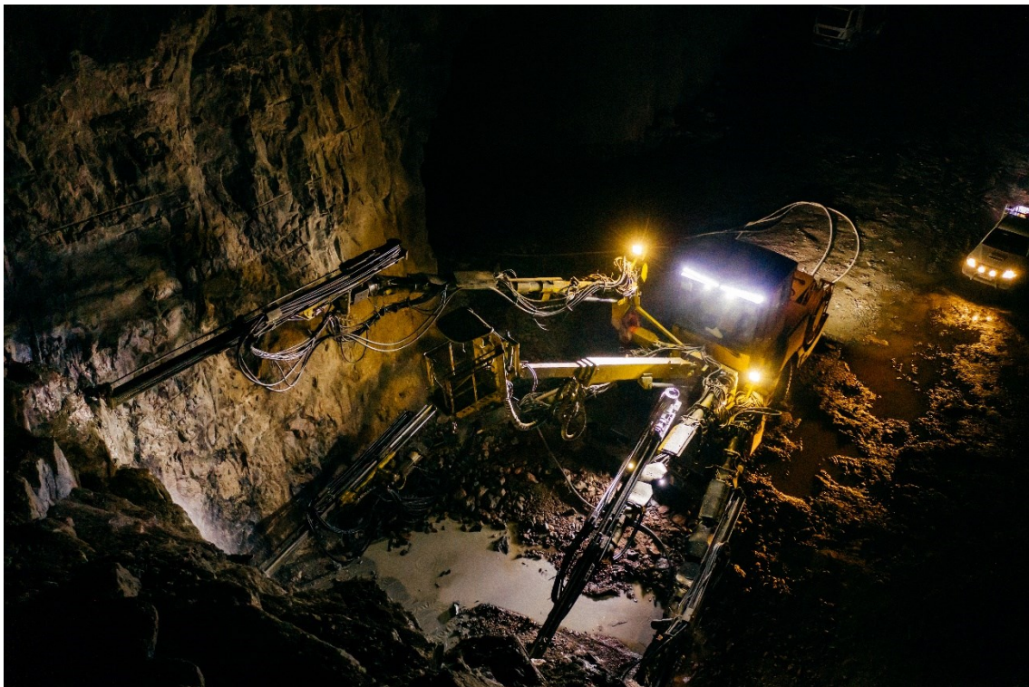
KUVA 1. Viisipuominen porajumbo, jossa viidennessä puomissa henkilönostin (YIT 2020)
