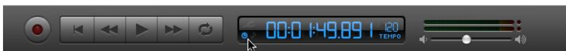
Kuva 11. Navigointi-ikkunasta voi valita mitä arvoja laskuri näyttää klikkaamalla hiiren vasemmalla näppäimellä pientä kellon tai nuotin kuvaa.
