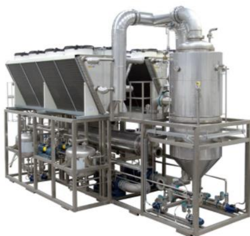
Kuva 16. Esimerkkikuva tyhjiöhaihduttimesta. (Tuset 2015, https://blog-en.condorchem.com/basis-vacuum-evaporation/#.YCL6ZOgzY2w , Luettu 18.12.2020.)
