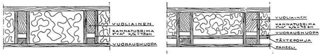
Kuva 11. Puurakenteinen välipohja (Särkinen 2005, 65).
