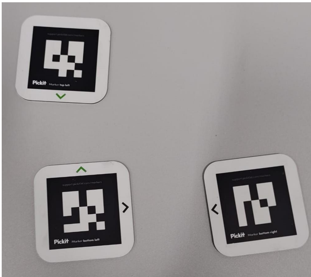
Kuva 16. Poiminta-astian opettamiseen käytettävät QR-laatat
