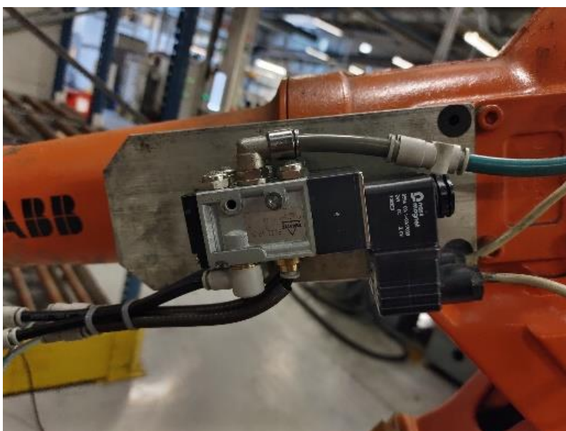
Kuva 21. Paineilmaventtiili ja ohjausjohtimet tarttujan ohjaamiseen
