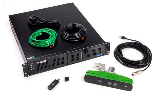
Kuva 4. Pickit M -kamera, tietokone sekä kaapelit (Pickit verkkosivut 2020)
