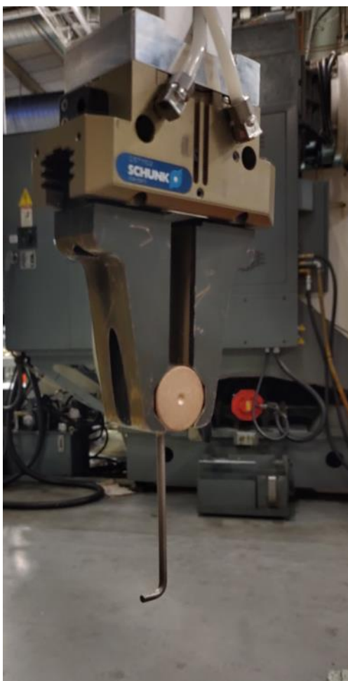
Kuva 30. Koukku, jota käytetään kappaleiden siirtämiseen, kun kappaleita ei enää ole poimittavissa asennoissa
