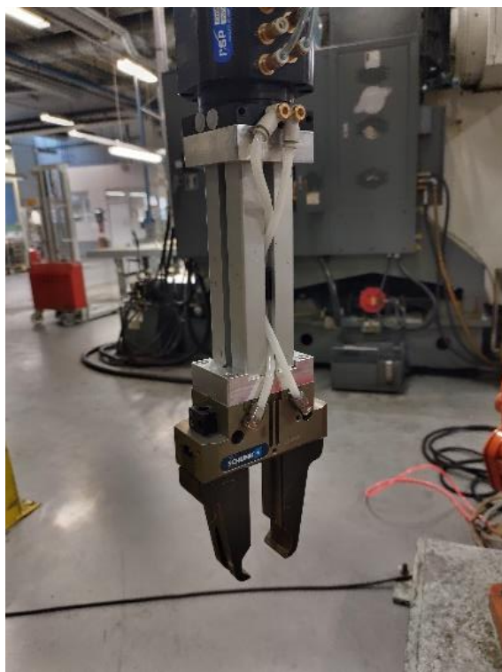
Kuva 19. Tarttuja, tarttujan varsi, tarttujan leuat ja paineilmaletkut tarttujan ohjausta sekä käyttövoimaa varten
