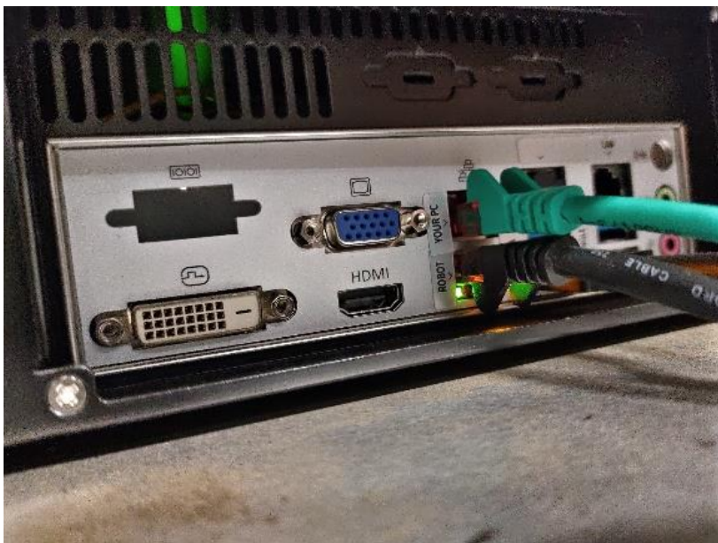
Kuva 22. Pickit-liitännät laitteen yhdistämiseksi tietokoneeseen ohjelmointia varten sekä robottiin ohjausta varten
