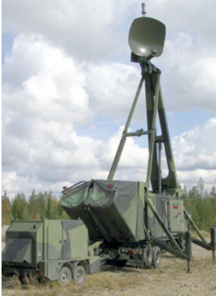
KUVIO 8. LÄVÄ-tutkajärjestelmä ja voimalaiteperävaunu (Puolustusvoimat 2012)
