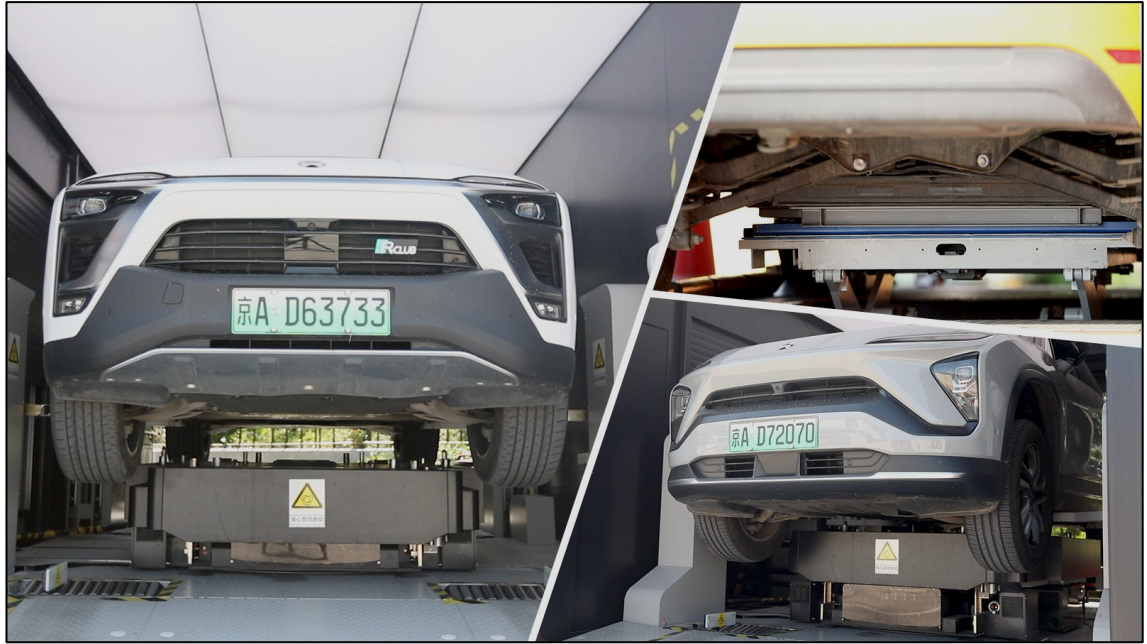
Kuva 18. Automaattinen akunvaihtopiste Kiinassa [26].
