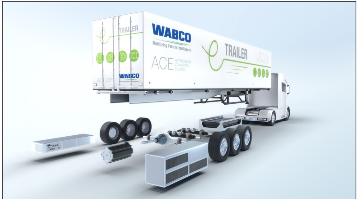
Kuva 1. Wabcon kehittämä perävaunu, joka avustaa vetoautoa sähkömoottorilla [6, s. 36–40].
