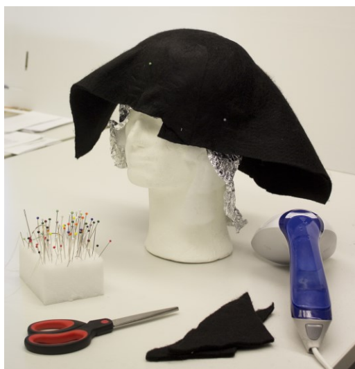
Kuva 8. Tuen valmistusta Fosshape-huovasta.
