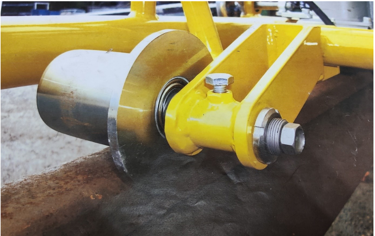
Kuva 7. Risteyshiomakoneen laipallinen kulkurulla (Konepaja Mankinen Oy, n.d.).
