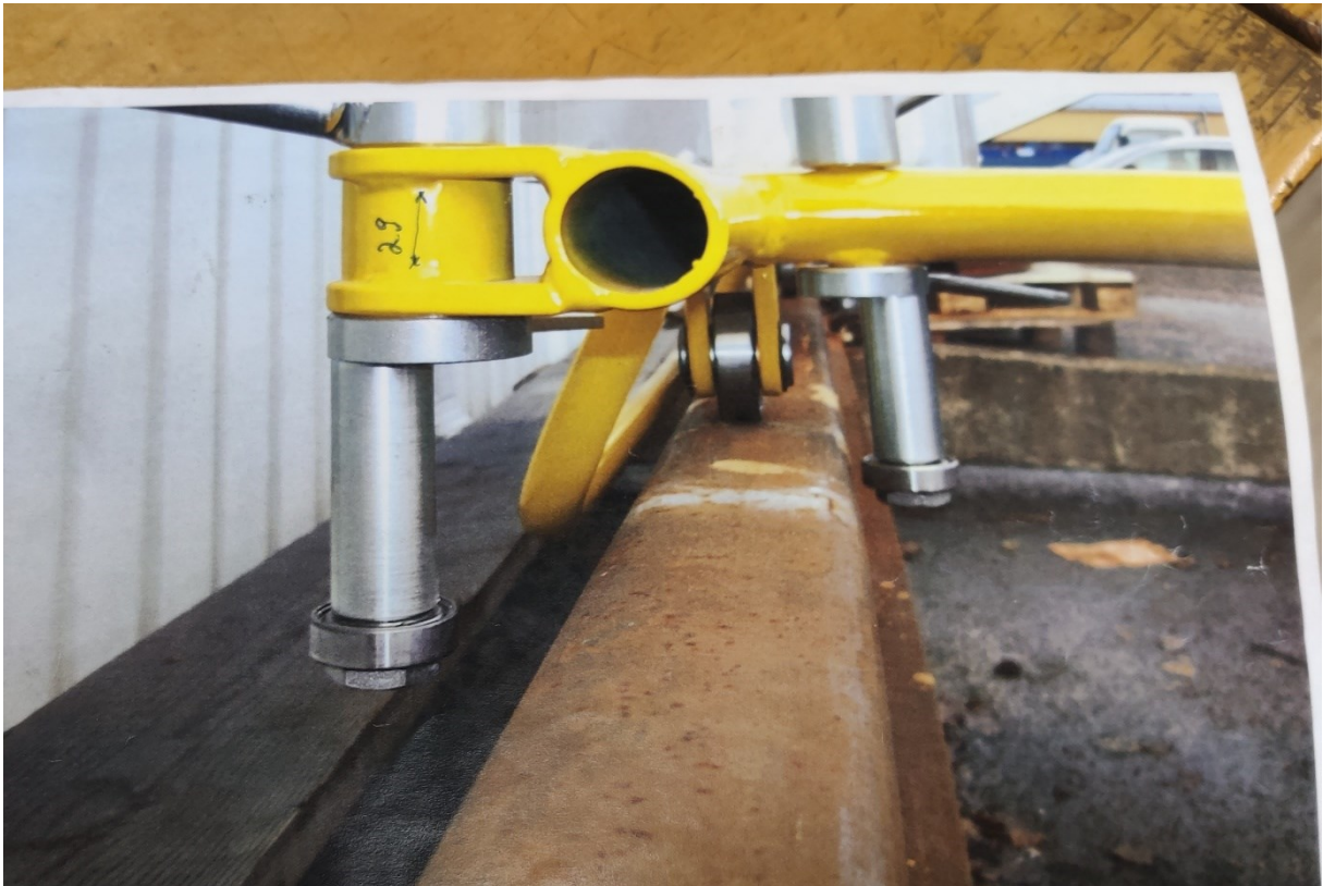
Kuva 6. Risteyshiomakoneen epäkeskoakselit (Konepaja Mankinen Oy, n.d.).
