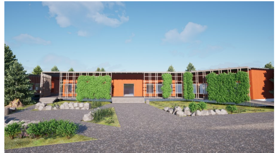
Kuva 45 Kuvamuunnos, jossa länsijulkisivun terassien rimarakenteita hyödynnetään pystysuorina viherpintoina. Rimarakenteet voidaan toteuttaa myös esimerkiksi kierrätetystä puumateriaalista. (Kuva tekijän)
