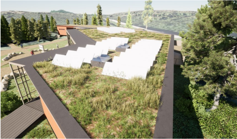
Kuva 46 Suunnitelmassa viherkatolle on sijoitettu luonnonmukaista pohjakasvillisuutta kuten heinää. Aurinkokeräimet tuottavat energiaa rakennuksen omaan käyttöön. (Kuva tekijän)
