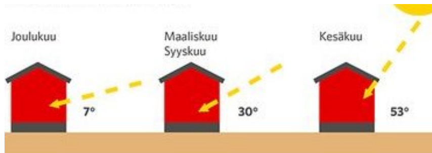
Kuva 4 Auringon kulma 60°N leveyspiirillä eri vuodenaikoina. (Kuva: motiva.fi)
