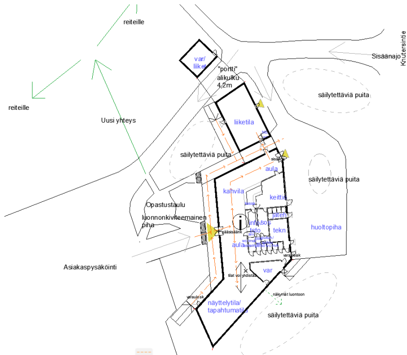
Kuva 38 Toiminnallinen tilakaavioluonnos suunnitelmasta. Tilojen sijoittelussa ja suuntauksessa on pyritty huomioimaan ilmansuunnat ja luonnonvalo. (Kuva tekijän)
