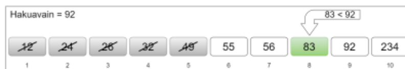
Kuva 8. Puolitetusta datasta valitaan keskimäinen arvo ja verrataan sitä hakuavaimen.
