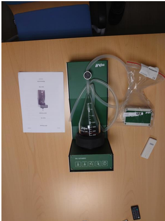
KUVA 10. MJK 780 – Näytteenotin. (Särkkä 2021, CC BY-SA).
