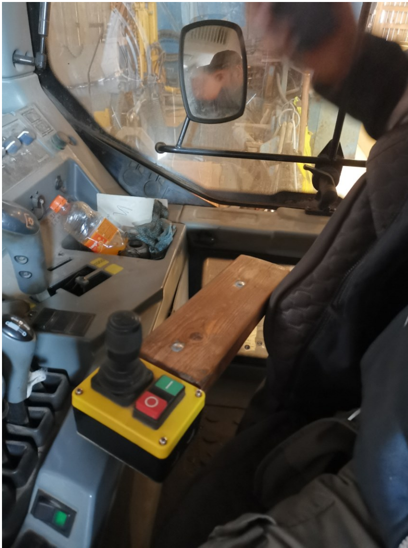
KUVA 6. Nostokoneen uudet hallintalaitteet (Kuva: Eelis Korjus 2020)
