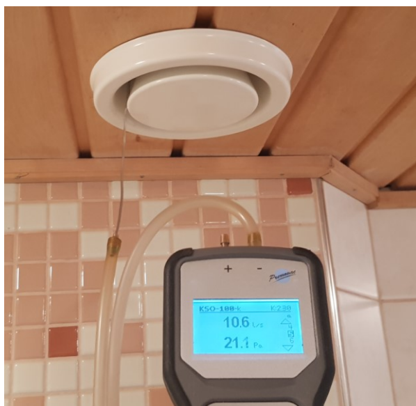
Kuva 14. Paine-erimittari Pressovac PHM-V1, jolla mitataan venttiilistä paine-eroa [14].
