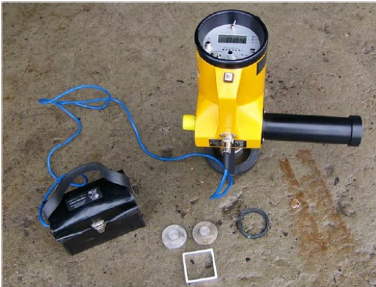
Kuva 16. Tartuntavetolaite Easy-M ja oheistarvikkeita (Väylävirasto, 2017 c, s.19)
