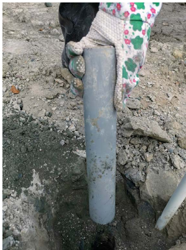
Kuva 22. Koeputkien irrotus koekentiltä. Liukoisuustestiin koottiin materiaali koeputken ympäriltä irronneesta massasta.
