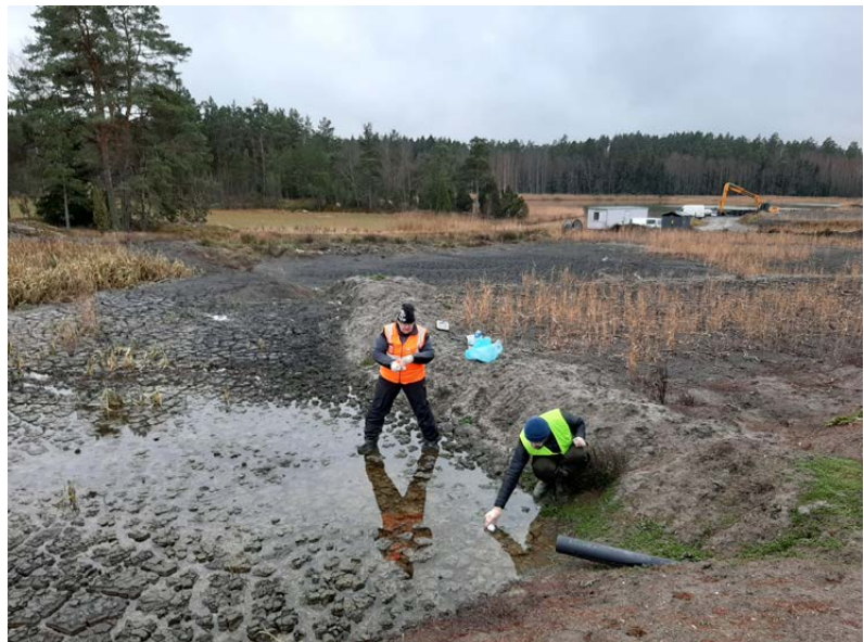
Kuva 66. Näytteenottoa 17.11.2020 hulevesikaivosta (näytepiste JAJA-2020-102 kuvassa 65) (vasemmalla) ja käsittelemättömän ruoppausmassan päällä olevasta vedestä (näytepiste JAJA-2020-107 kuvassa 65) (oikealla).
