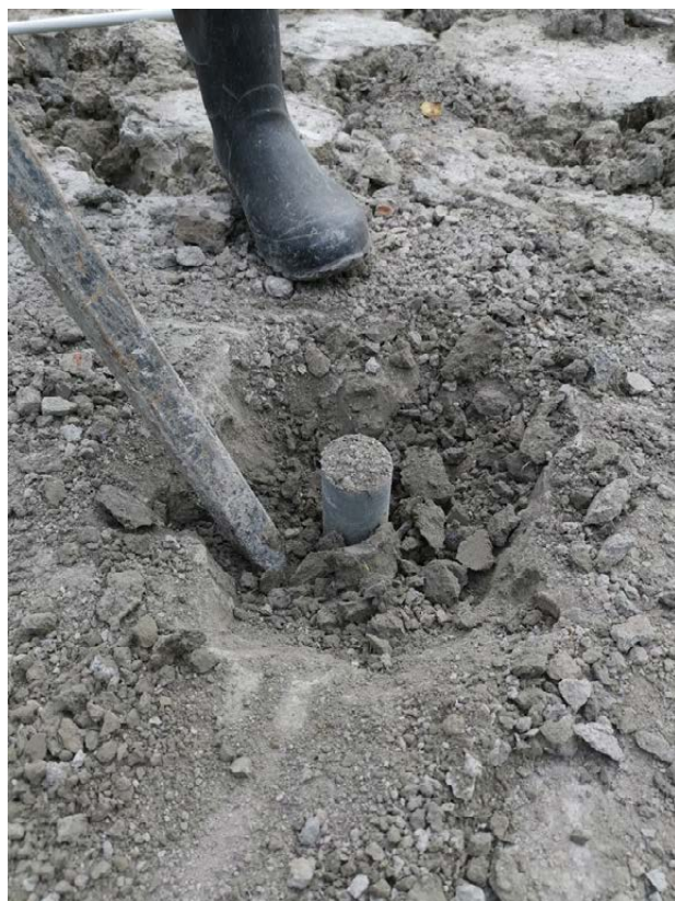
Kuva 22. Koeputkien irrotus koekentiltä. Liukoisuustestiin koottiin materiaali koeputken ympäriltä irronneesta massasta.
