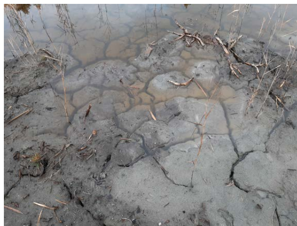
Kuva 58. Kuivuneeseen ruoppausmassaan syntyneitä kuivumisrakoja (2.9.2020) (vasemmalla) ja sateiden myötä veden alle joutunutta ruoppausmassaa (17.11.2020) (oikealla).
