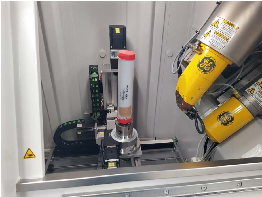
Kuva 37. Ruoppausmassanäyte koeruudusta 1 (resepti 1) valmiina kuvattavaksi tomografialaitteessa.
