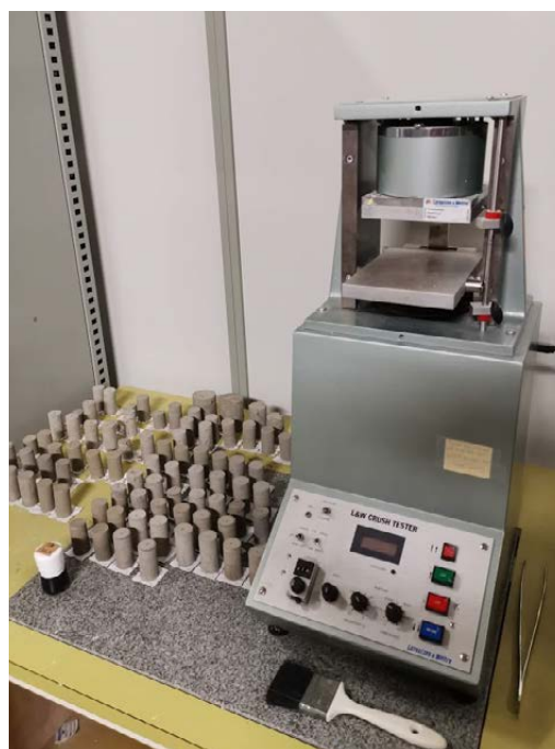
Kuva 8. Näytteiden puristuslujuuden testaamiseen käytetyt laitteet. Turun AMK:n käyttämä laite, VjTech Triplex III (vasemmalla) ja Åbo Akademin käyttämä laite, L&W (oikealla).
