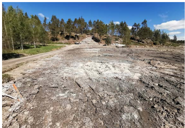
Kuva 24. Koeruudut valmiina (vasemmalla) ja koko koekenttä valmiina tuhkalisäyksen jälkeen (oikealla).
