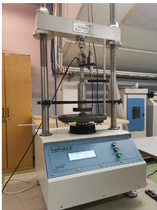
Kuva 8. Näytteiden puristuslujuuden testaamiseen käytetyt laitteet. Turun AMK:n käyttämä laite, VjTech Triplex III (vasemmalla) ja Åbo Akademin käyttämä laite, L&W (oikealla).
