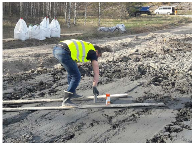
Kuva 21. Näyteputkien asentaminen koeruutuihin sideaineiden sekoittamisen jälkeen.
