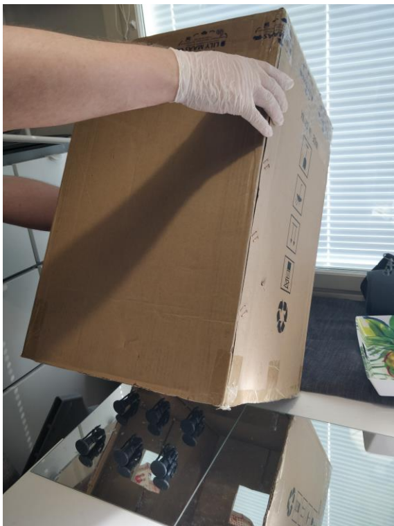
KUVA 54. Kovetusaseman pahvilaatikko asetettiin miniatyyrien peililevyjen päälle.
