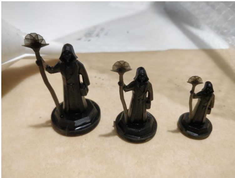
KUVA 42. Eri kokoisia miniatyyrin prototyyppejä. Sauvan päässä sijaitsevat kortit olivat niin ohuita, että ne olivat läpikuultavia.
