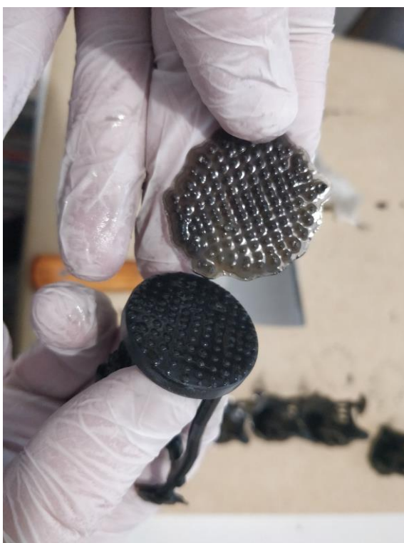
KUVA 47. Myöskään pohjan tukien irrottamisessa ei tarvittu työvälineitä.
