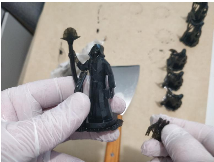
KUVA 46. Sivutukien irrottamista. Koska tuet olivat sopivan paksuisia ja niissä oli katkaisukohtat, tuet irtosivat kevyesti vääntämällä.
