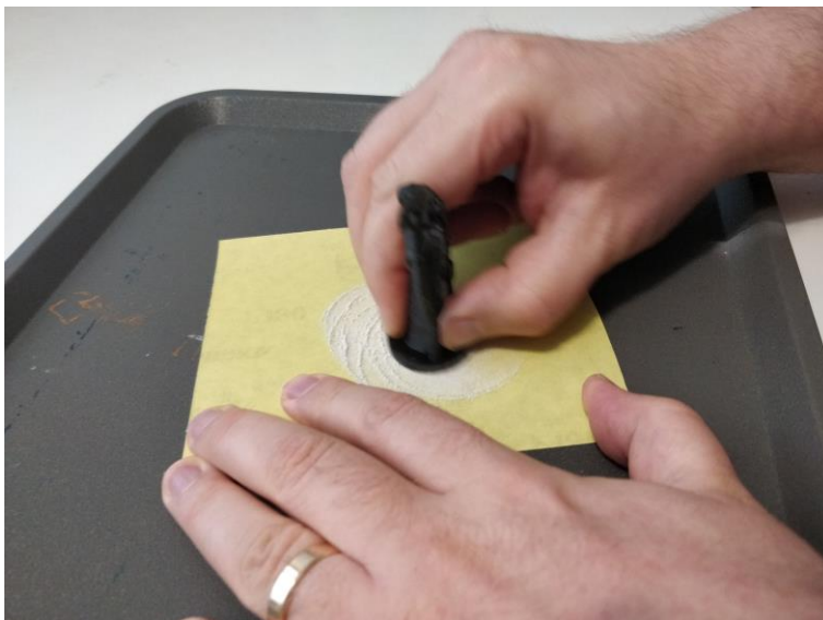
KUVA 60. Miniatyyrien tasaiset pohjat hiottiin pyörivillä liikkeillä 180 karheuden hiekkapaperilla.
