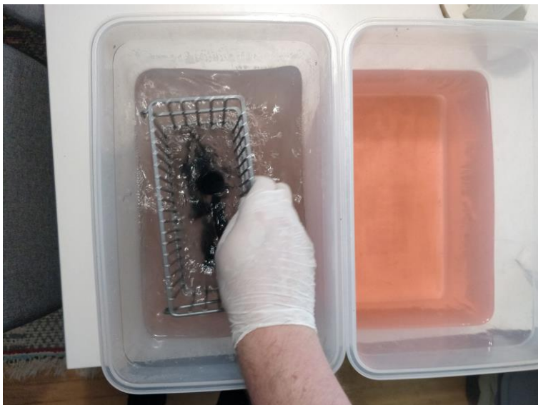
KUVA 48. Huuhtelu ensimmäisessä huuhteluastiassa, mihin valtaosa kovettamattomasta hartsista huuhtoutuu.
