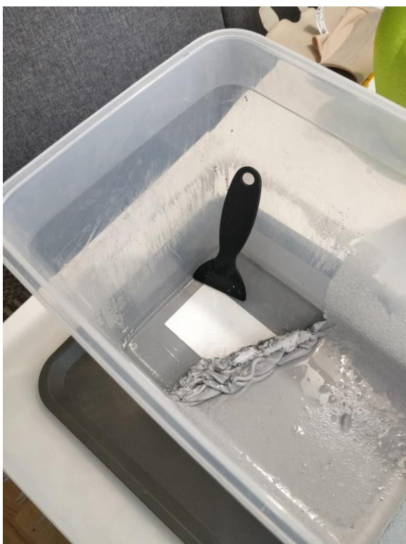
KUVA 33. Muovinen lasta ei vahingoita muovista huuhteluastiaa.
