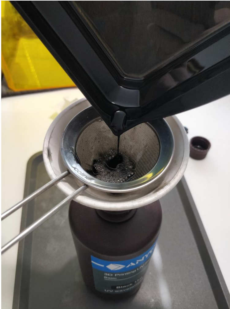
KUVA 34. Siivilä kerää kovettuneet hartsiartikkelit hartsista.
