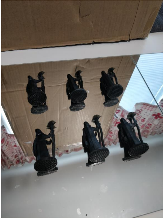
KUVA 58. Kovetetut miniatyyrit. Miniatyyrit tuntuvat käsiin kuivilta ja kiinteämmiltä kovettamisen jälkeen.
