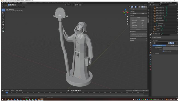
KUVA 24. Miniatyyrin 3D-mallin lopullinen versio. Heikkoja kohtia vahvistettiin ja hahmoa muutettiin katsomaan ylöspäin tulostamisen helpottamiseksi.
