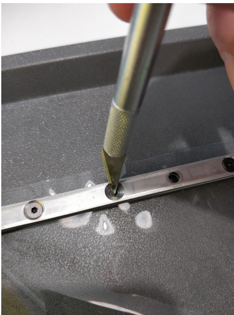
KUVA 39. Ruuvit yltävät helpommin kierteille, jos kalvo on puhkaistu.
