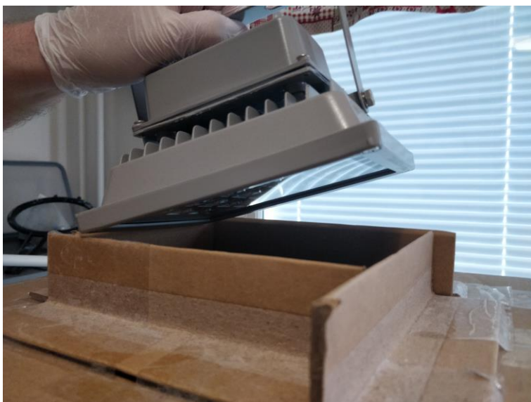
KUVA 55. UV-lamppu asetettiin kovetusaseman katon aukkoon.
