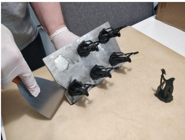
KUVA 45. Ohuet pohjalevyt ja niiden kaltevat reunat edesauttoivat miniatyyrien irrottamista.
