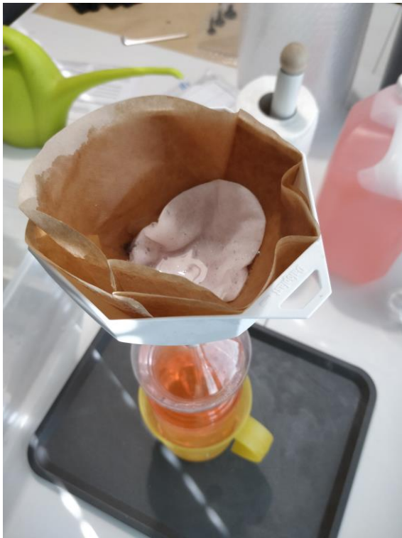
KUVA 31. Vanutyyny kerää hartsi partikkeleita tehokkaasti spriistä.
