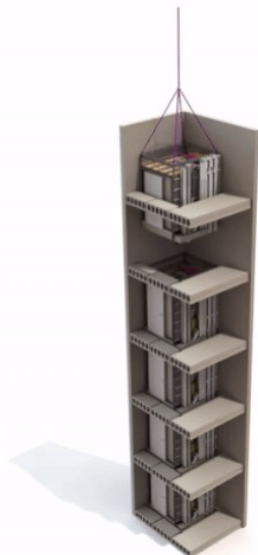
Kuva 10. Kuiluasennuksen peruseriaate (Fira Modules 2021).
