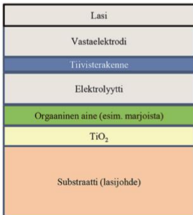
Kuva 9. Väriaineherkistetyn paneelin rakenne (Kuva: ST-käsikirja 40 2017).
