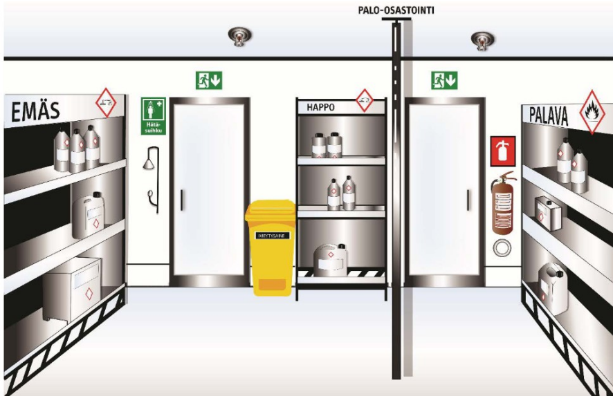
Kuva 2. Yleiskuva astiavarastosta sisällä. (Turvallisuus- ja kemikaalivirasto, 2019)
