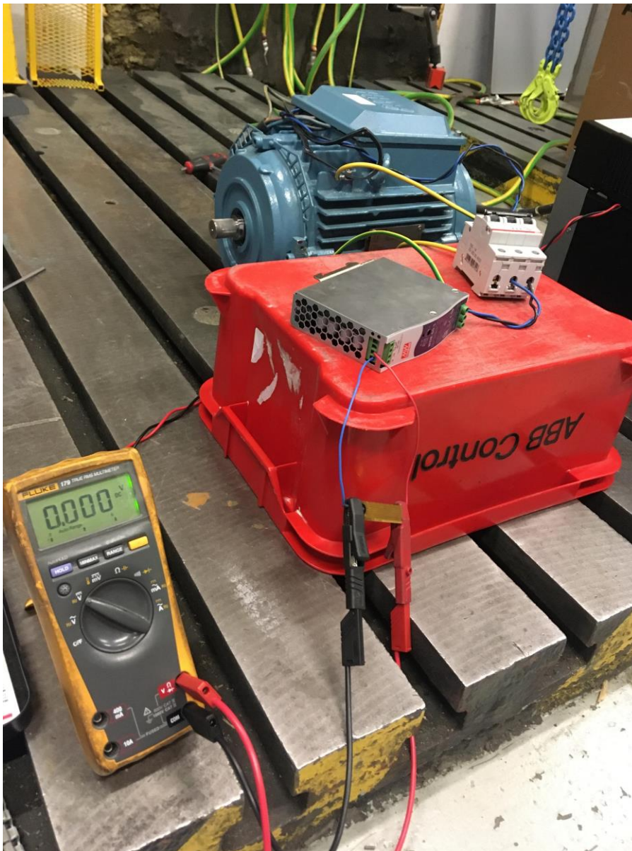
Kuva 27. Tehonlähteen kytkentä ensimmäisessä taajuusmuuttajalla syötetyssä testissä.
