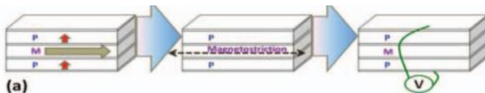
Kuva 3. Pietsosähköisen joustavan laminaatin rakenne. /6/
