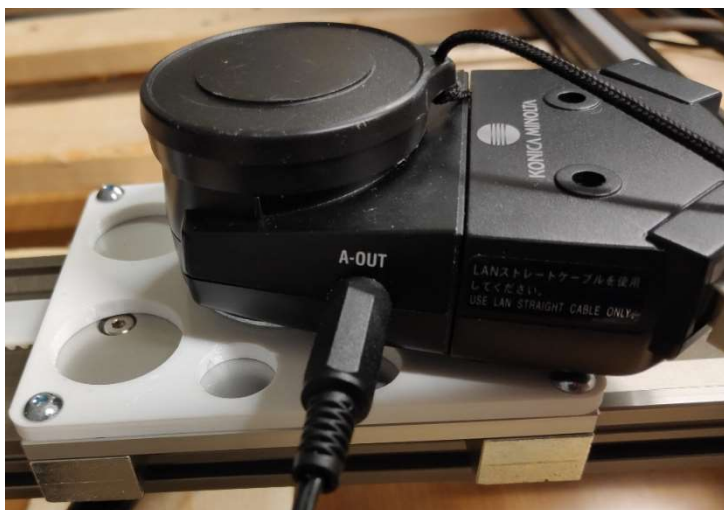
Kuva 4. Anturin mittapään kiinnitystä varten 3D-tulostettu adapteri käytössä
