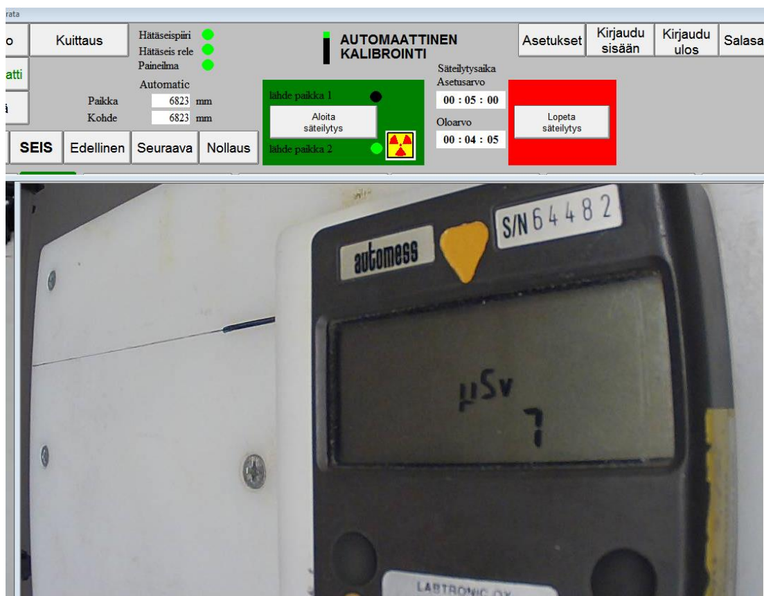
Kuva 21 Annoksen laskenta Automess 6150AD 2 annosnopeusmittarissa
