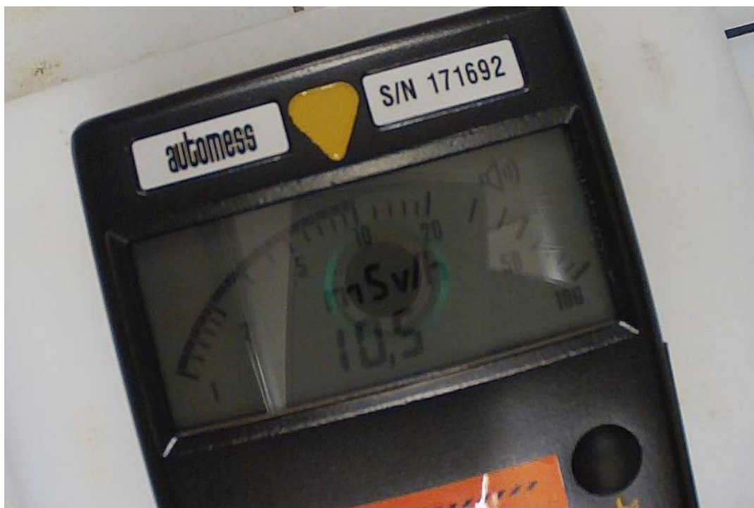
Kuva 12. IP-kameralla otettu kuva Automess annosnopeusmittarista
