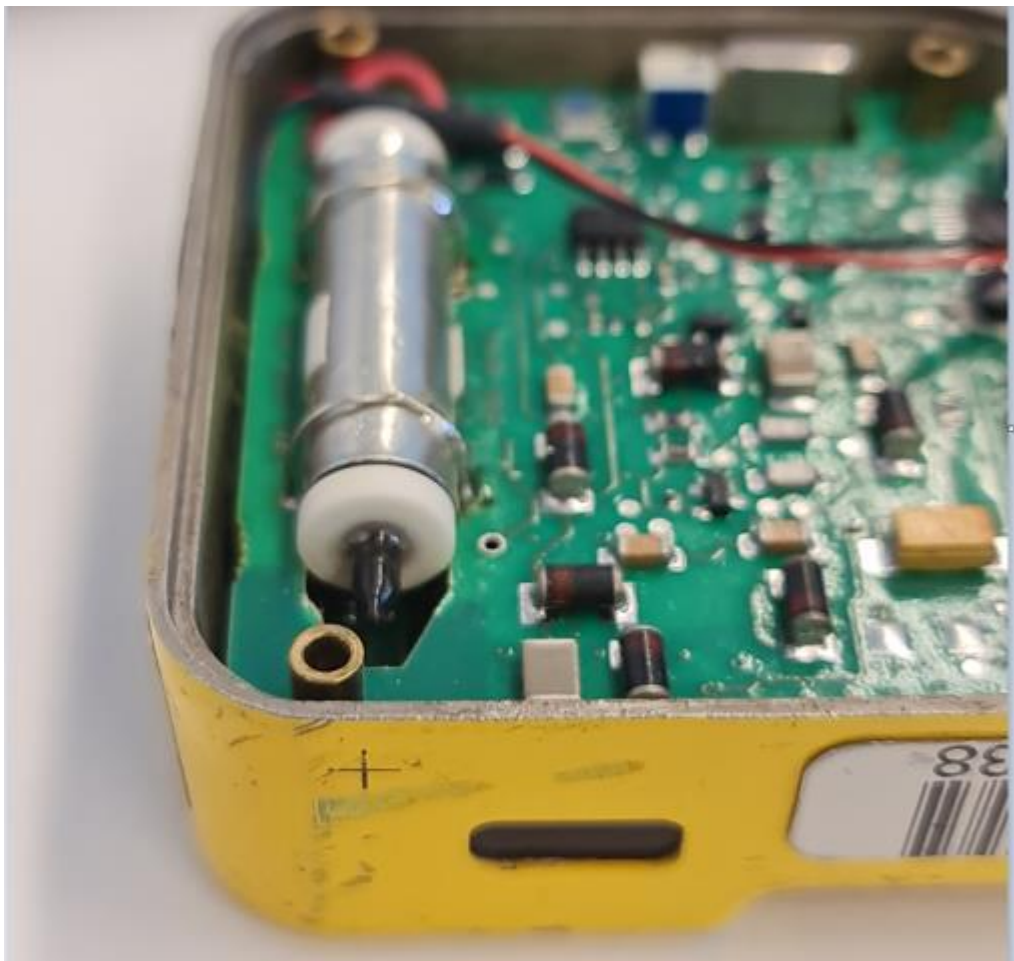
Kuva 1. Ultraradiac annosnopeusmittarin GM-putki
