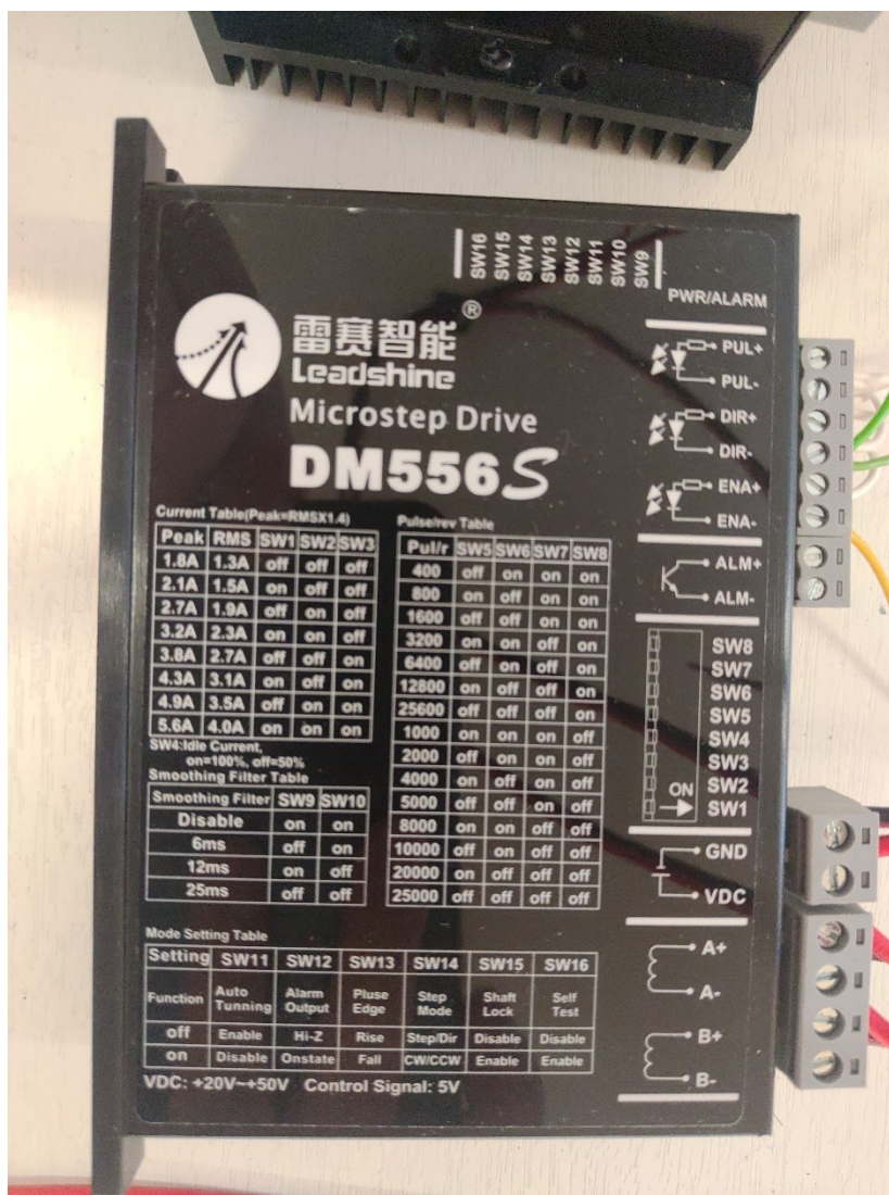
Kuvio 1. DM556S mallinen askelmoottoriohjain, jossa taulukoissa esitetty asetusvaihtoehdot.
