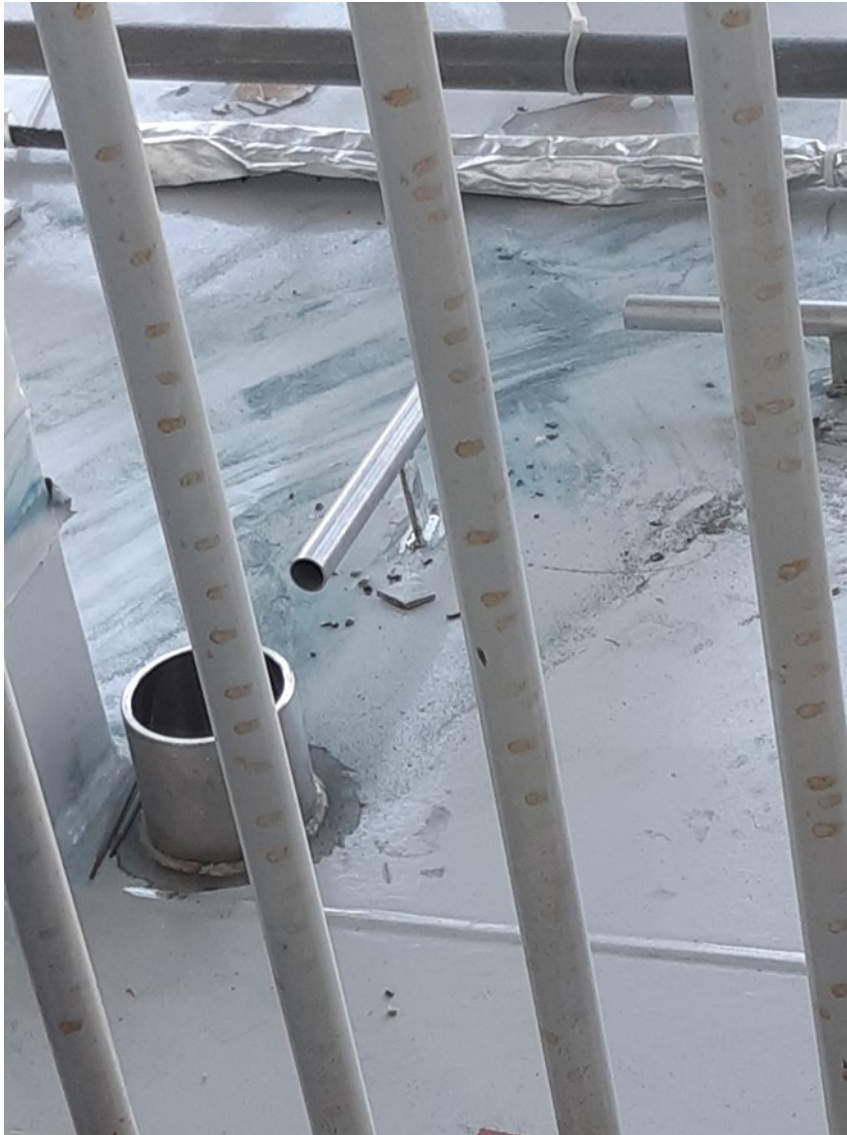
Kuva 6. Uudelleensijoitettu sähköläpivienti Mardi Gras -aluksen venekannella. (Meyer Turku Oy, 2021.)
