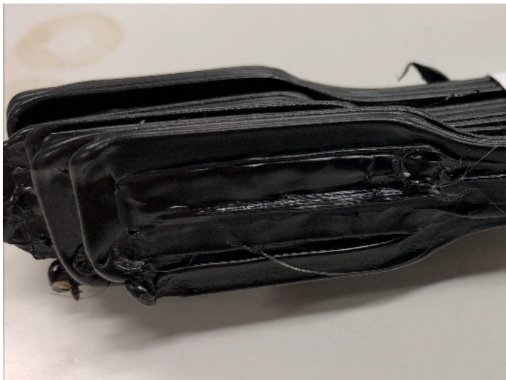
Kuva 37. 3 mm:n suuttimella tulostetun vetosauvan leveä kohta.
