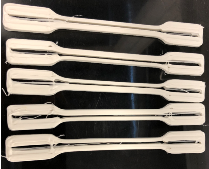
Kuva 27. Kappaleen lineaarinen täyttökuviointi.
