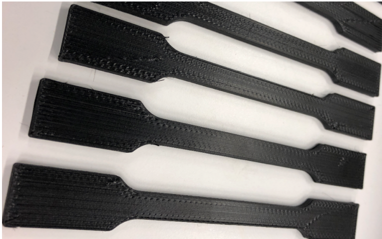
Kuva 38. 0,6 mm:n suuttimella tulostettuja ABS-vetosauvoja.
