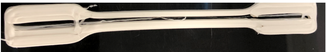
Kuva 28. Lineaarisen täyttökuvioinnin ongelmakohta.
