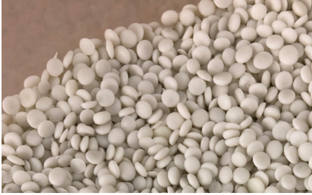
Kuva 14. Työssä käytetty Biodolomer F40 900310 PLA.
