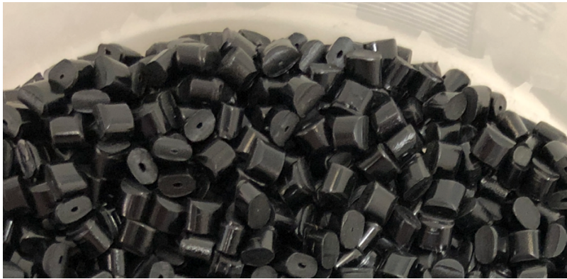
Kuva 17. Työssä käytettyä uusio-ABS-tulostusmateriaalia RR3010.
