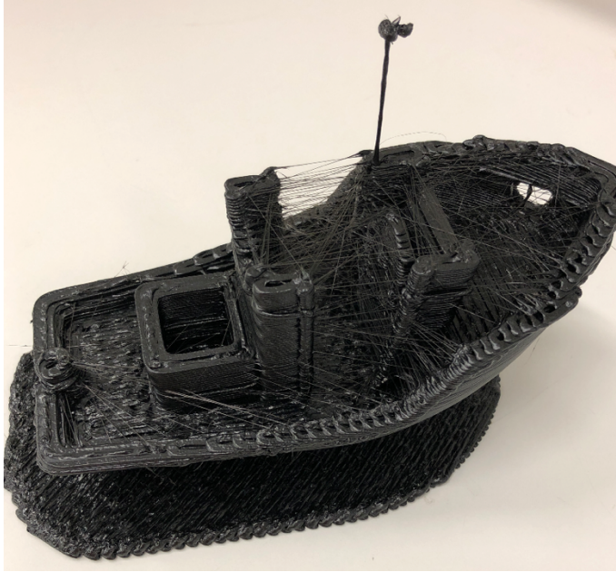
Kuva 42. 3DBenchy ABS-muovilla ja materiaalialustalla.
