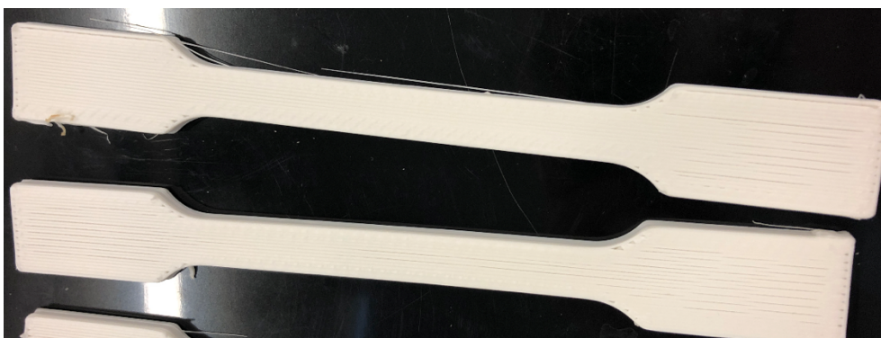
Kuva 32. Muutetuilla prosessiparametreilla tulostettuja sauvoja 0,6 mm:n suuttimella.
