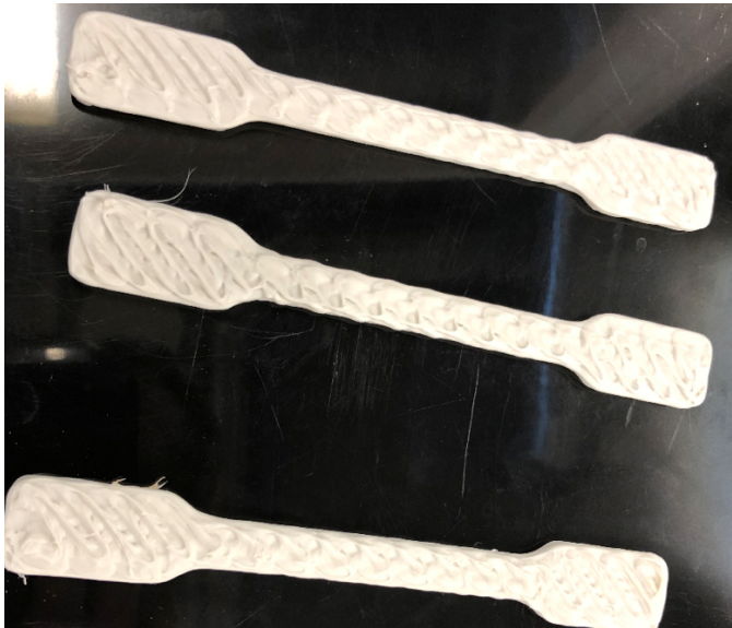
Kuva 25. Kappaleen täyttö lisätty 100 %:iin.
