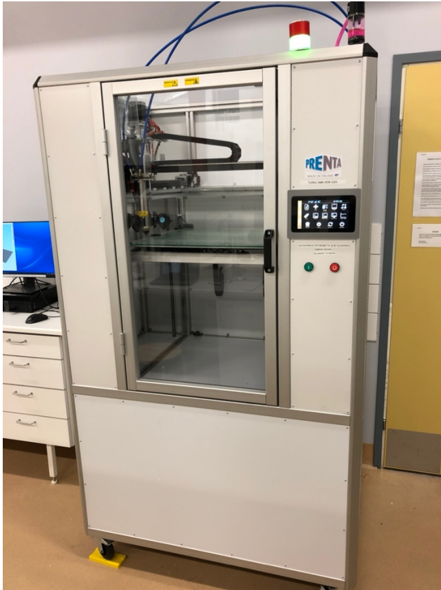
Kuva 11. Prenta Oy:n FGF-450 isosuuttimellinen tulostin.
