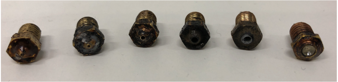
Kuva 13. FGF-450 3D-tulostimen suuttimet.
