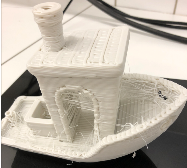
Kuva 34. 3DBenchy-malli tulostettuna 2 mm:n suuttimella.
