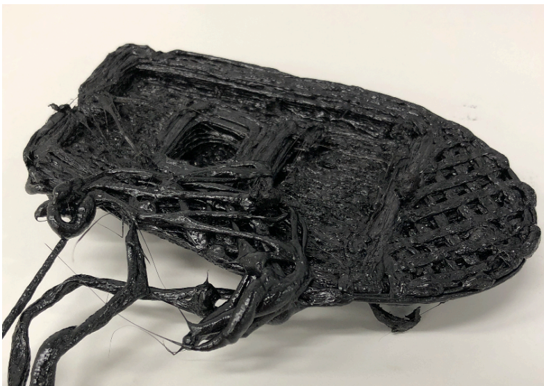
Kuva 40. Epäonnistunut 3DBenchy-malli ABS-muovilla.
