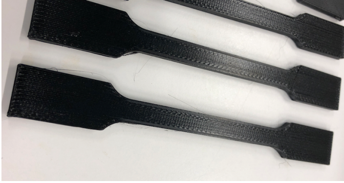
Kuva 39. 0,6 mm suuttimella hienosäädetty pursotuskerrointa ABS-muoville.
