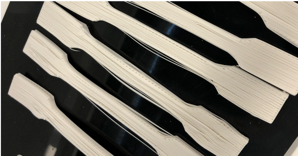
Kuva 31. Kerrosten adheesioongelma 0,6 mm:n suuttimella.
