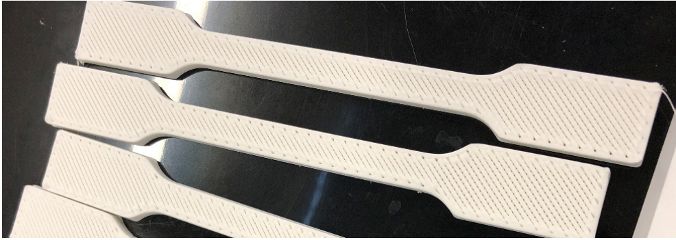
Kuva 30. 1 mm:n suuttimella tulostettuja vetosauvoja.
