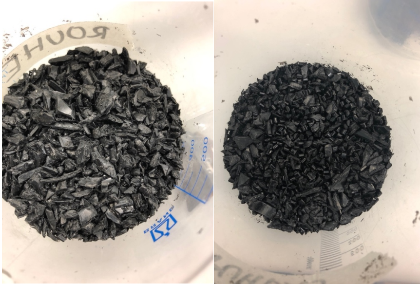
Kuva 22. Uusiosyöttömateriaali sekä seos ensiö- ja uusiomateriaalia (ABS-muovi).
