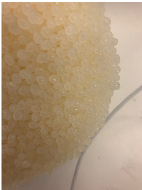
Kuva 23. Mallikuva työssä käytetystä ensiö-PLA-muovigranulaatista.
