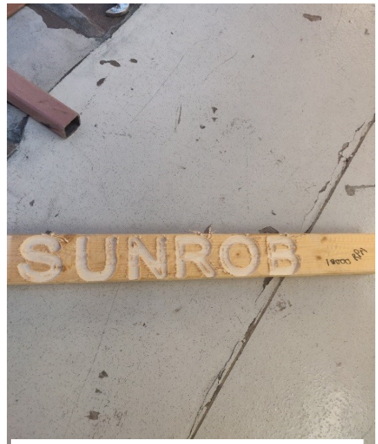
Kuva 11. Sama kuvio 10000 rpm kierrosnopeudella ja hieman suuremmalla syöttönopeudella.
