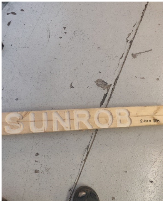
Kuva 10. Ensimmäinen jyrshintätesti 2000 rpm kierrosnopeudella ja hyvin hitaalla syöttönopeudella.
