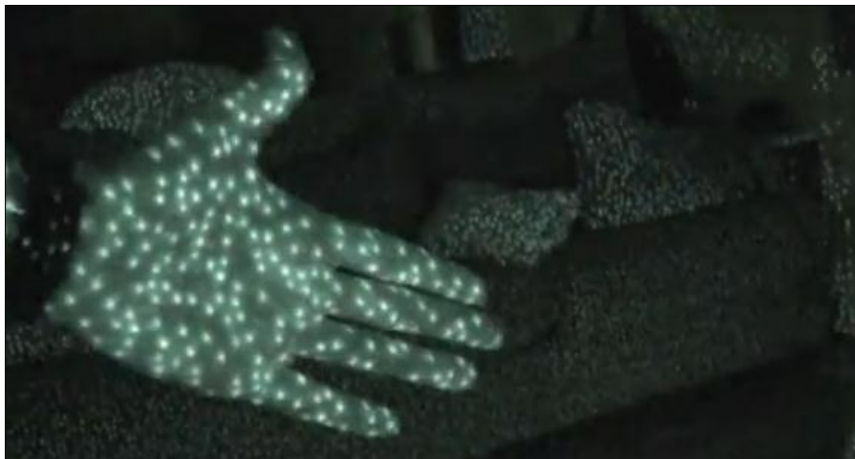
Kuva 5. Laserpistekuvio kuvattuna infrapunakameralla (Carmody 2010)
