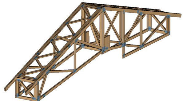
NR-rakenteiset vaaka- ja pukkiristikot muodostavat jäykistysjärjestelmän.
