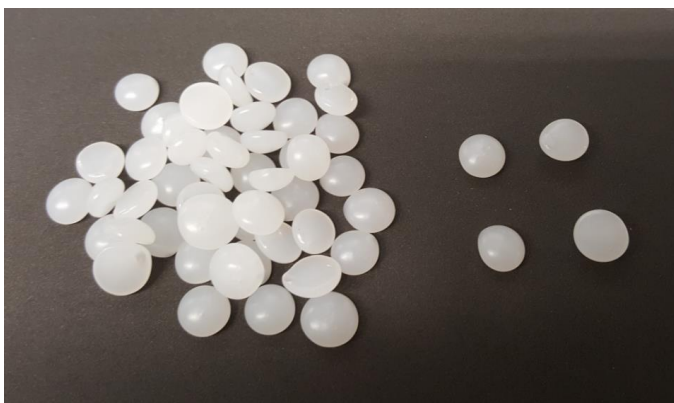
KUVA 5. Esimerkki tuotannon yhteydessä valmistetuista sulateliimapastilleista. Pellettien koko vaihtelee tuotteiden välillä (Virtanen 2021)
