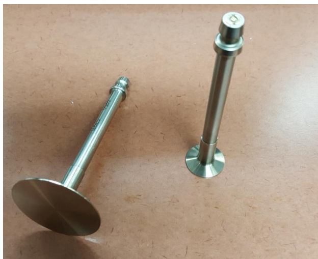
KUVA 4. Käytetyt mittauspäät. Vasemmalla PP50 ja oikealla PP25 (Virtanen 2021)
