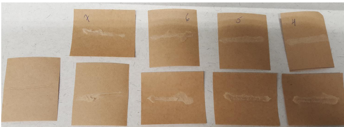
KUVA 2. Olinger-laitteessa avointa aikaa mitatessa käytetyt kartonkipalat 4–7 sekunnin odotusajoilla. Vasemmalla laitteen applikoima liimaraita ilman puristusta (Virtanen 2021)
